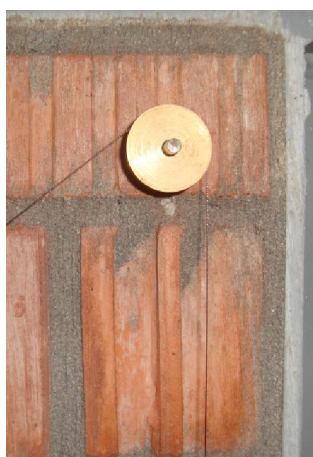
Slika 4.32 - Mjerenje produljenja/skraćenja dijagonala zidanog ispuna
