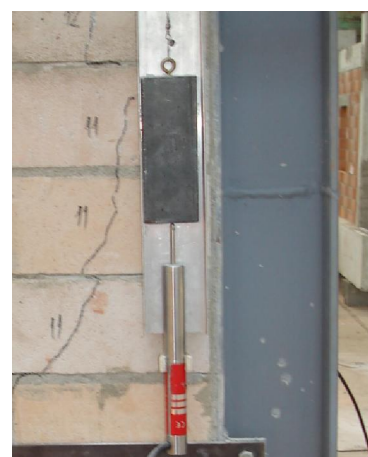
Slika 4.32 - Mjerenje produljenja/skraćenja dijagonala zidanog ispuna
