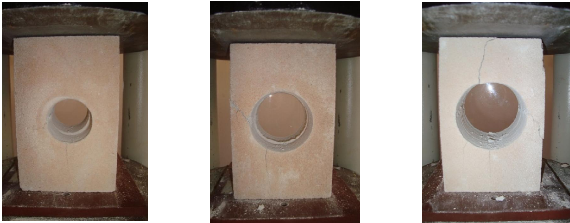
Slika 4.8– Ispitivanje izbušenih porobetonskih blokova
