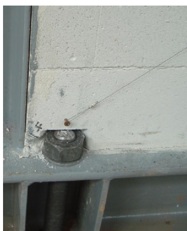
Slika 4.32 - Mjerenje produljenja/skraćenja dijagonala zidanog ispuna
