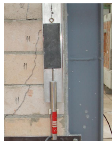
Slika 4.32 - Mjerenje produljenja/skraćenja dijagonala zidanog ispuna
