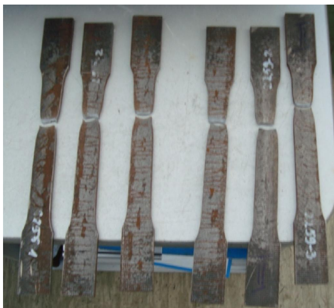
Slika 4.15 – Ispitani uzorci čelika
