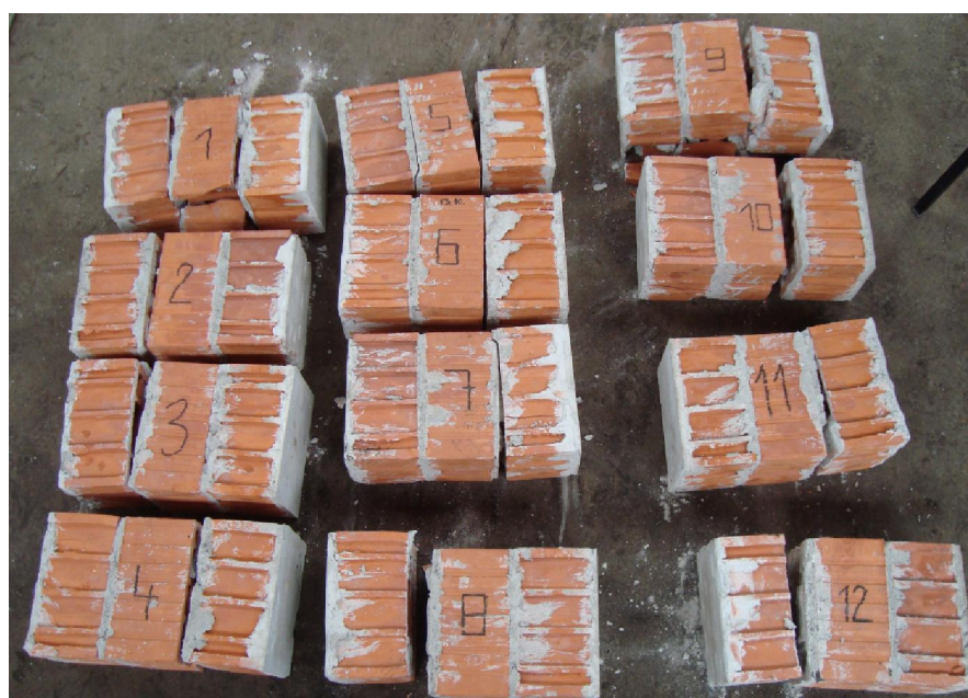
Slika 4.21 – Određivanje posmične čvrstoće – ispitani uzorci
