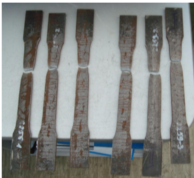
Slika 4.15 – Ispitani uzorci čelika
