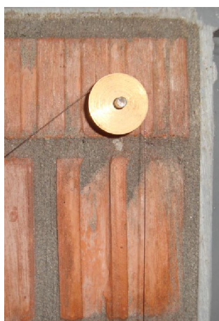
Slika 4.32 - Mjerenje produljenja/skraćenja dijagonala zidanog ispuna
