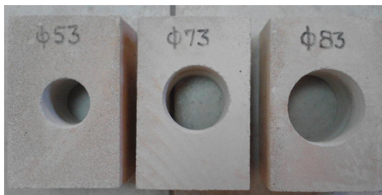
Slika 4.7 – Izbušeni porobetonski blokovi
