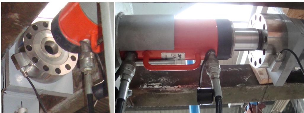
Slika 4.27 – Unošenje opterećenja u čelični okvir
