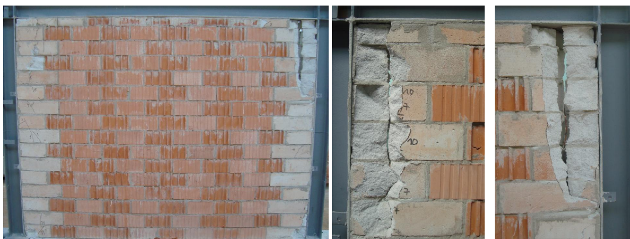
Slika 4.76 – Oštećenja okvira sa zidanim ispunom – OGY-1
