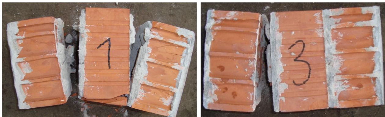
Slika 4.20 – Ispitivanje posmične čvrstoće: a) nepravilan oblik sloma, b) pravilan oblik sloma
