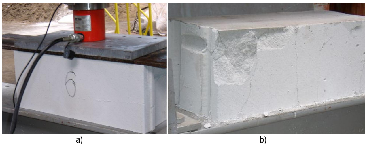
Slika 4.6 – Ispitivanje punog zidnog elementa od porobetona (a), porobetonski blok nakon sloma (b)
