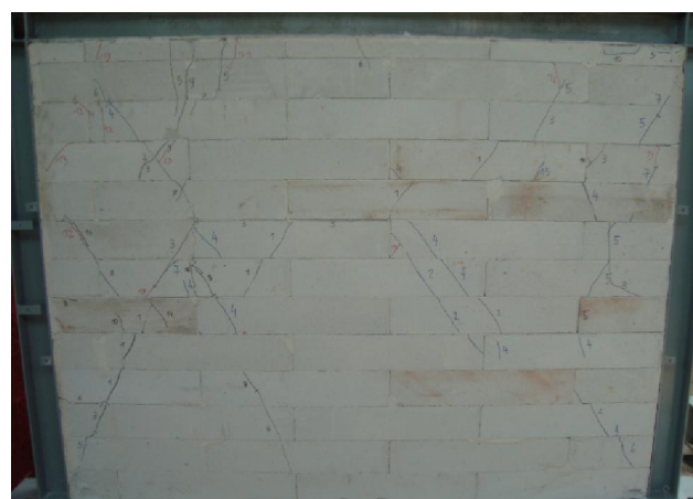
Slika 4.74 – Oštećenja okvira sa zidanim ispunom: a) okvir OG-3, b) okvir OY-1
