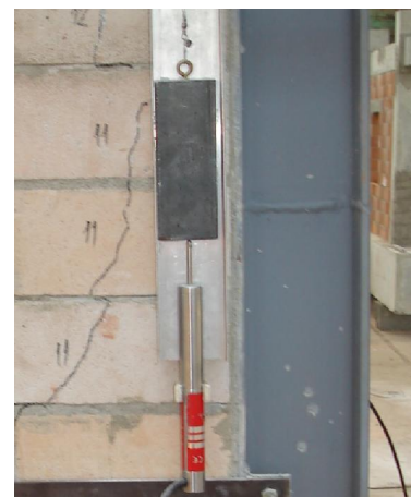
Slika 4.32 - Mjerenje produljenja/skraćenja dijagonala zidanog ispuna
