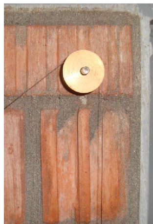
Slika 4.32 - Mjerenje produljenja/skraćenja dijagonala zidanog ispuna
