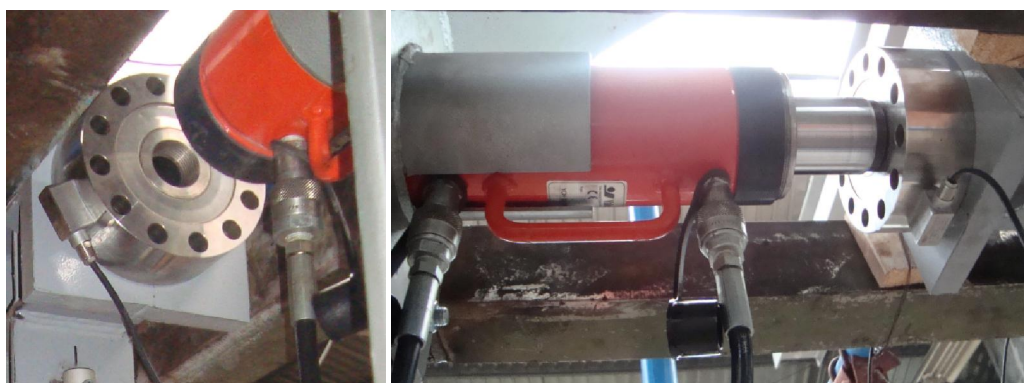
Slika 4.27 – Unošenje opterećenja u čelični okvir
