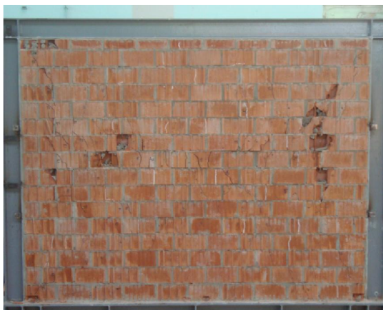
Slika 4.73 – Oštećenja okvira sa zidanim ispunom: a) okvir OG-1, b) okvir OG-2
