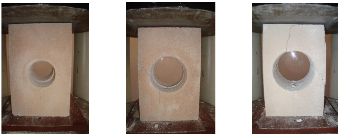
Slika 4.8– Ispitivanje izbušenih porobetonskih blokova
