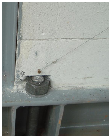
Slika 4.32 - Mjerenje produljenja/skraćenja dijagonala zidanog ispuna
