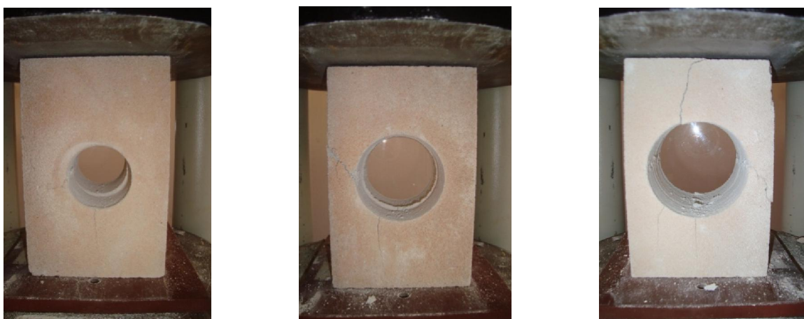
Slika 4.8– Ispitivanje izbušenih porobetonskih blokova
