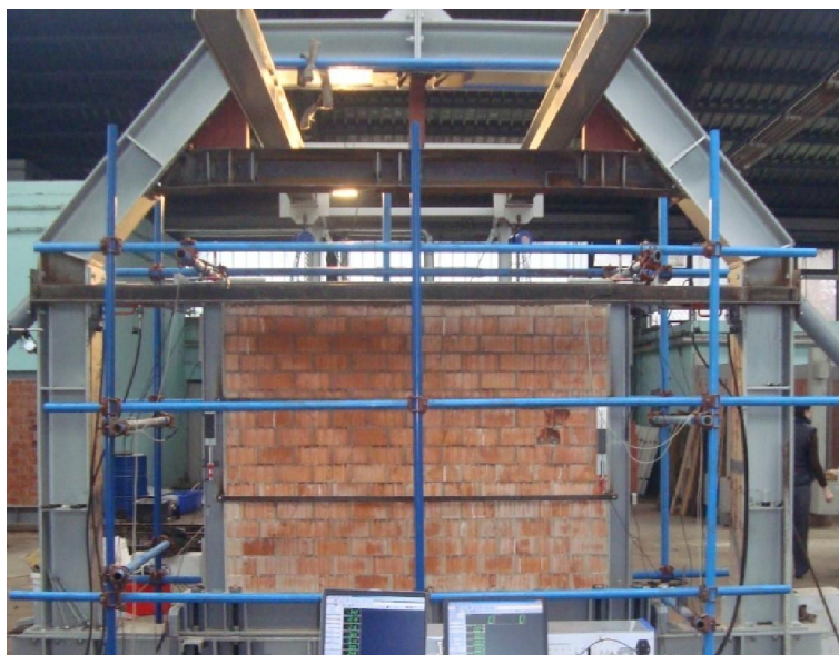
Slika 4.35 - Ispitivanje čeličnog okvira sa zidanim ispunom od šupljih glinenih blokova (OG-i)
