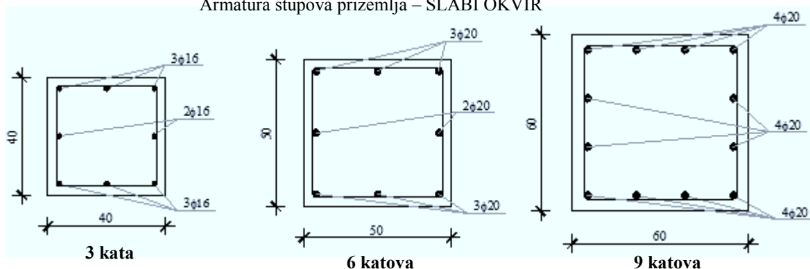
Armatura stupova prizemlja – SLABI OKVIR
