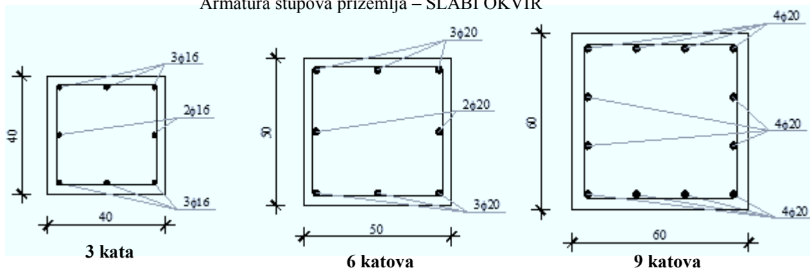
Armatura stupova prizemlja – SLABI OKVIR
