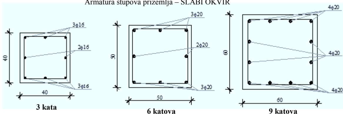
Armatura stupova prizemlja – SLABI OKVIR
