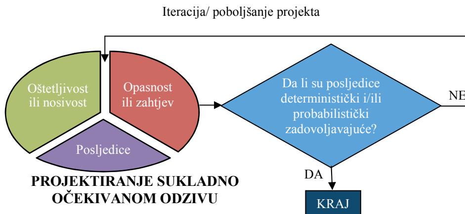
Slika 111. Dijagram toka projektiranja sukladno očekivanom odzivu, (Tang,2008)
