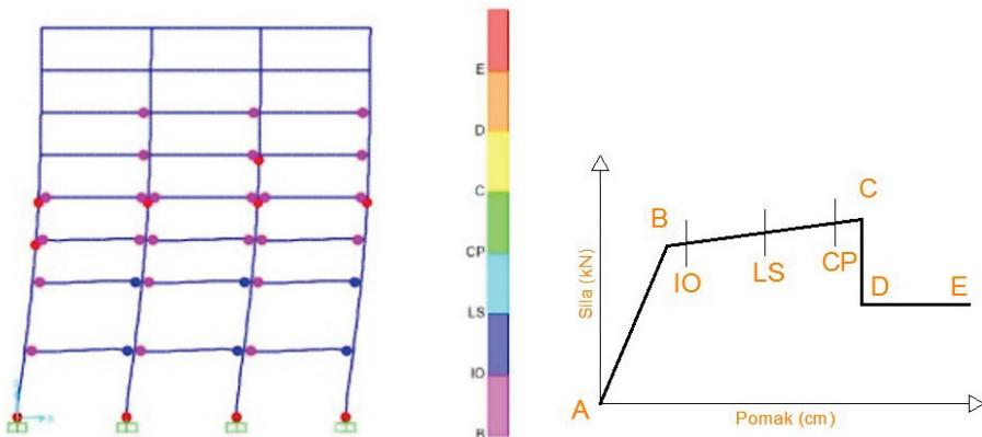
*Slika 6. Mesta nastanka plastičnih zglobova u konstrukciji i pripadajuće razine plastifikacije, tj. oštećenja*
