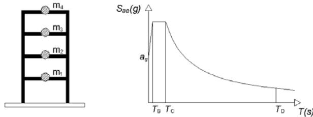
**Slika 1.** Primjer modela konstrukcije (lijevo) i potresni zahtjev (desno) (prema[6])
