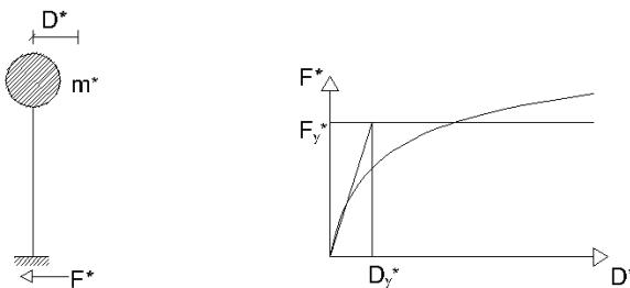
**Slika 3.** Ekvivalentni model s jednim stupnjem slobode (lijevo) i odgovarajući dijagram odnosa sile-pomak za ekvivalentni model (desno) (prema [1])
