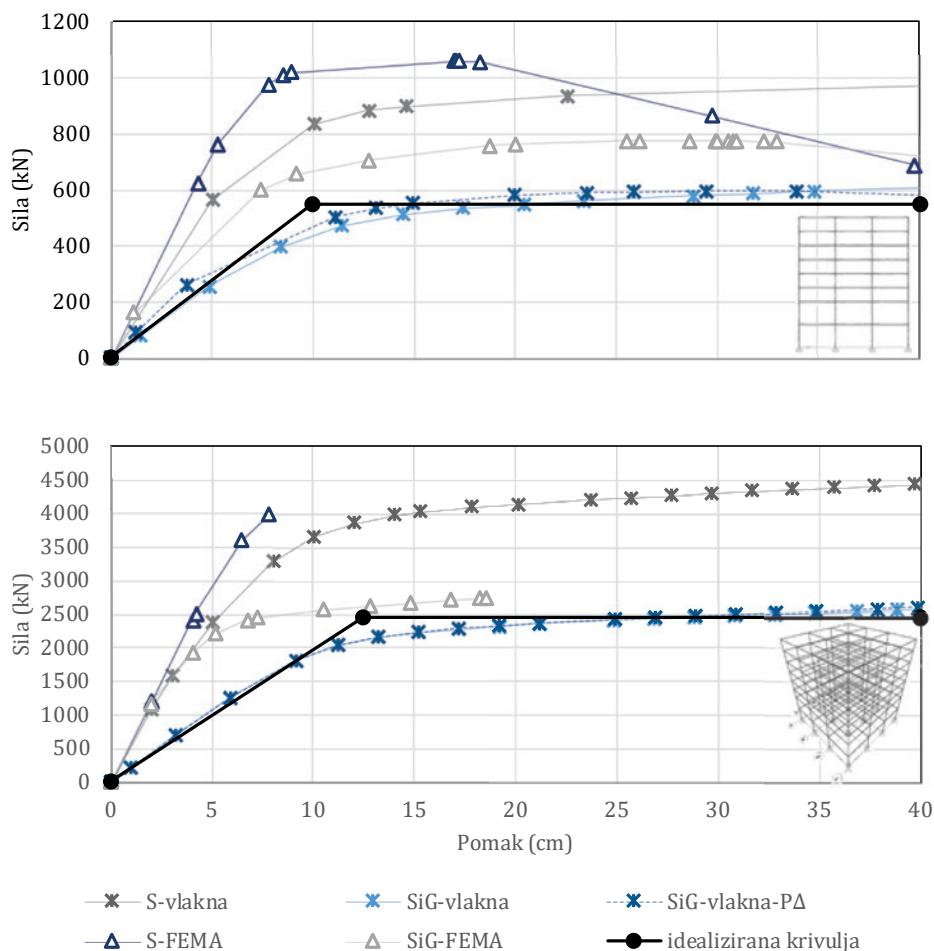
**Slika 13.** Krivulje kapaciteta za model K8R3-2D (gore) i model K8R3-3D (dolje), oba opterećena trokutastom raspodjeljom horizontalnog opterećenja
