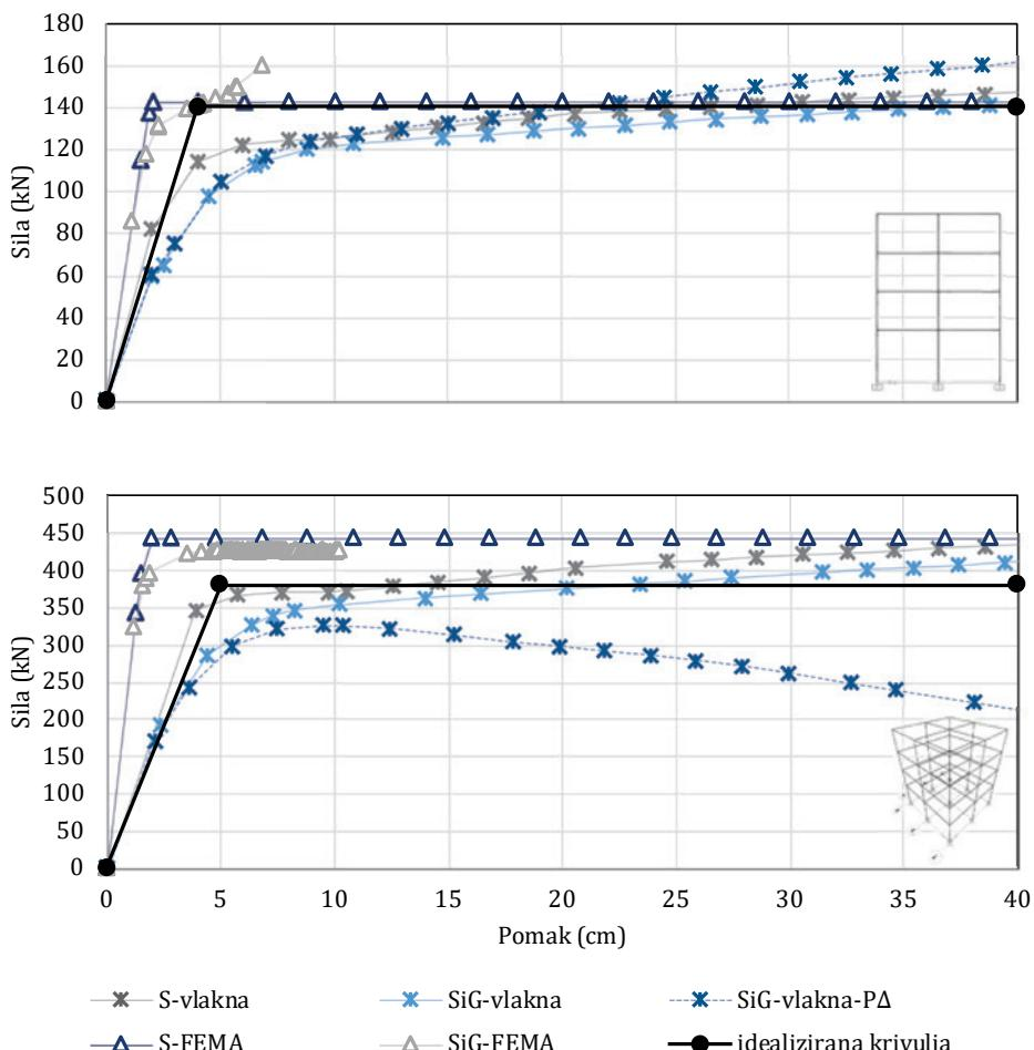
**Slika 12.** Krivulje kapaciteta za model K4R2-2D (gore) i model K4R2-3D (dolje), oba opterećena trokutastom raspodjeljom horizontalnog opterećenja
