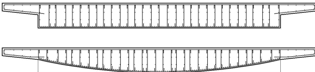
Slika 6.3 – Raspored armature pločastog sklopa
