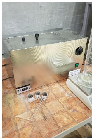
Slika 6.9: Ispitivanje postojanosti obujma
