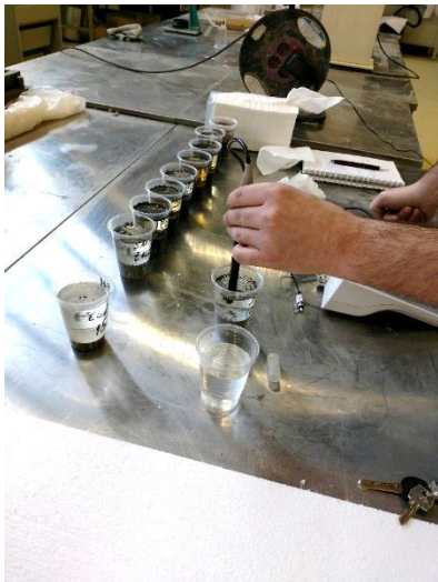
Slika 6.6: Ispitivanje pH-vrijednosti vode pomiješane s pepelima
