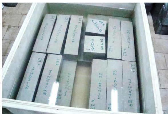
Slika 6.18: Njega uzoraka betona pod vodom
