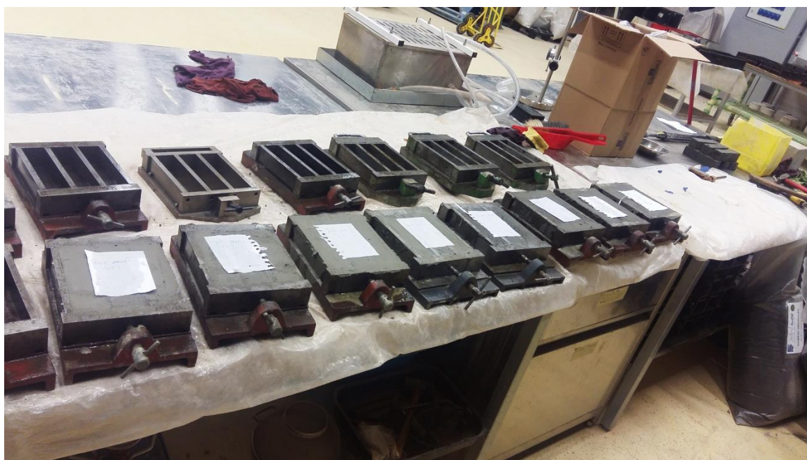
Slika 6.12: Uzorci ugrađeni u kalupe
