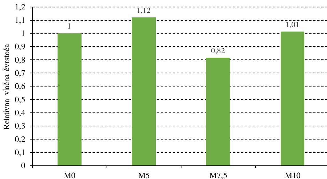
Slika 6.20: Relativne vlačne čvrstoće betona s pepelom ljuske sjemenki suncokreta kao zamjenom dijela cementa maseno
