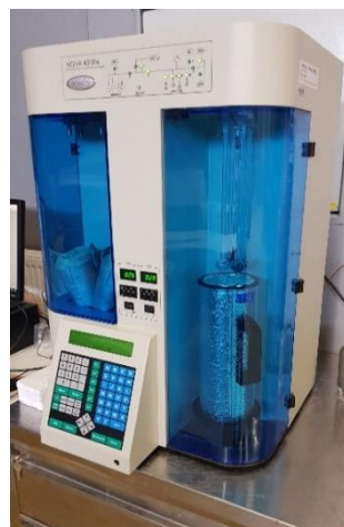
Slika 6.10: Ispitivanje specifične površine BET metodom
