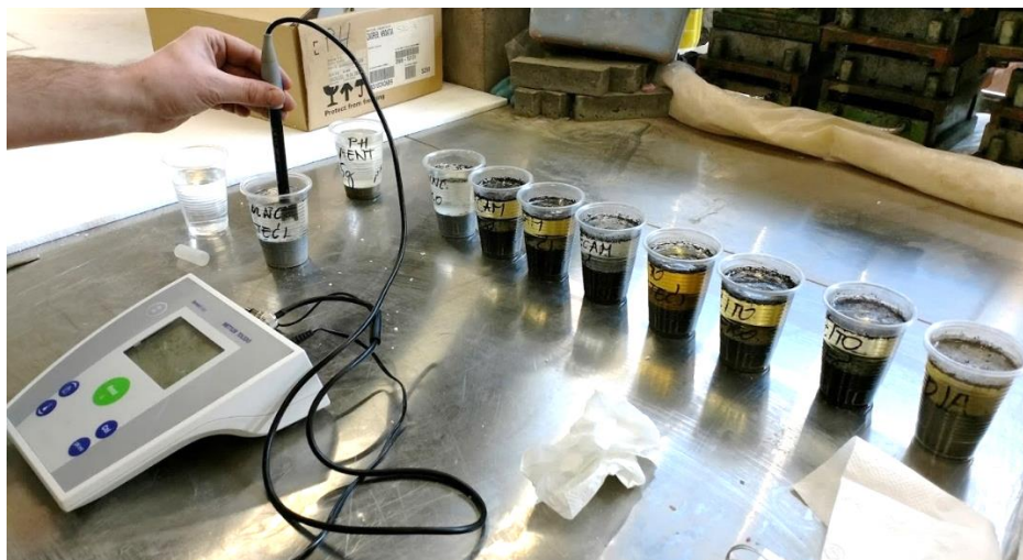
Slika 6.25: Mjerenje pH radi definiranja optimalnoga sastava stabiliziranoga tla
