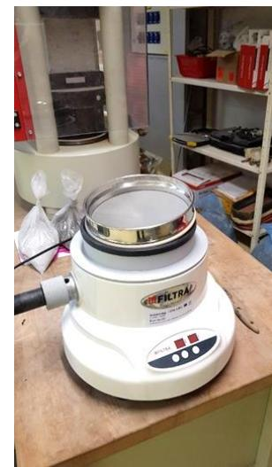
**Slika 6.8:** Prosijavanje na sitima sijačicom zračnim mlazom
