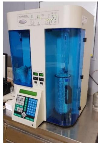
**Slika 6.10:** Ispitivanje specifične površine BET metodom
