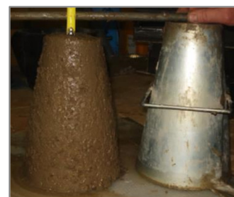
Slika 5. 11: Konzistencija slijeganjem MM-B10
