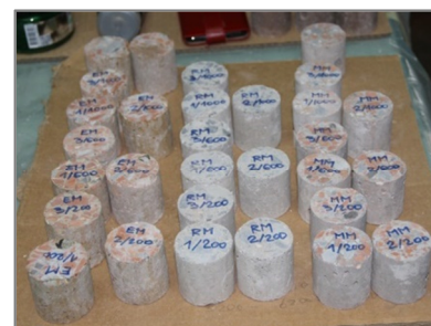
Slika 5. 19: Uzorci za ispitivanje plinopropusnosti
