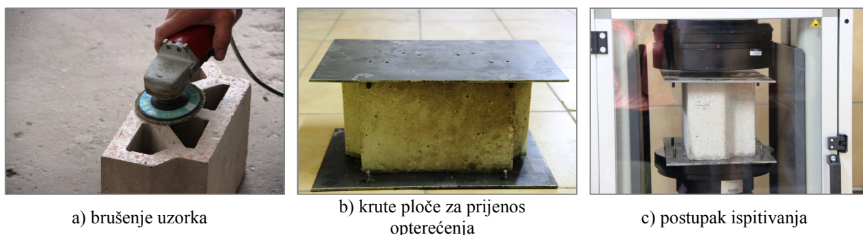
Slika 6. 7: Ispitivanje tlačne čvrstoće u horizontalnom smjeru
