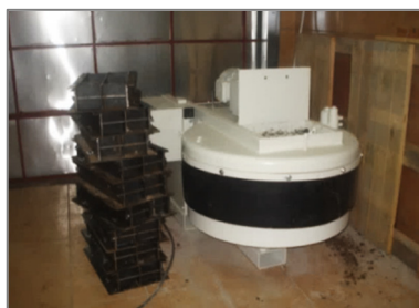
Slika 5. 6: Mješalica za izradu betonskih mješavina
