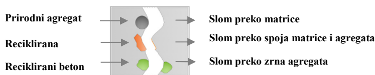
Slika 2. 6: Shema površina loma za različite agregate, [27]
