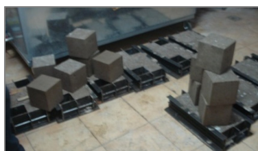
Slika 5. 12: Uzorci u kalupima i nakon vađenja iz kalupa
