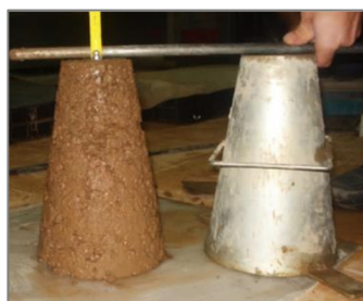
Slika 5. 10: Konzistencija slijeganjem EM-B42
