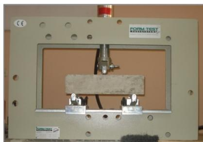
Slika 5. 18: Ispitivanje vlačne čvrstoće savijanjem
