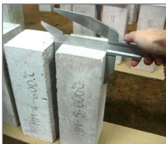
Slika 5. 14: Mjerenje dimenzija uzoraka
