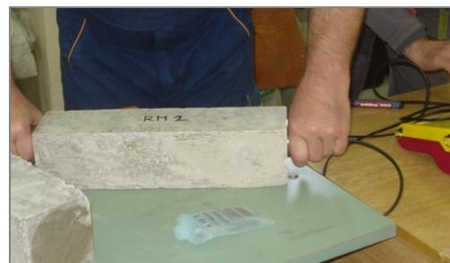
Slika 5. 16: Ispitivanje brzine prolaza ultrazvuka
