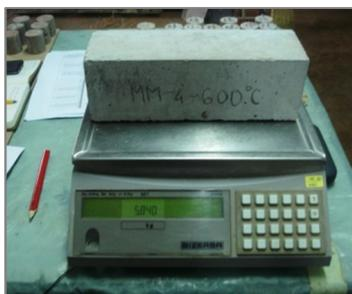
Slika 5. 15: Mjerenje mase uzoraka
