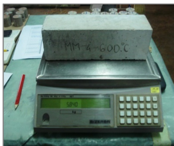
Slika 5. 15: Mjerenje mase uzoraka
