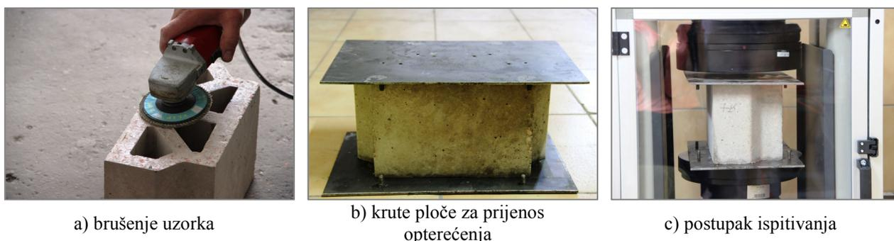
Slika 6. 7: Ispitivanje tlačne čvrstoće u horizontalnom smjeru
