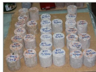
Slika 5. 19: Uzorci za ispitivanje plinopropusnosti
