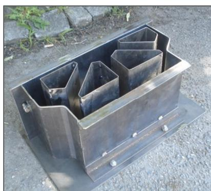
Slika 6.1: Izgled kalupa za izradu blokova
