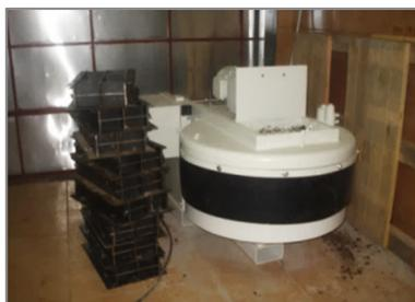
Slika 5. 6: Mješalica za izradu betonskih mješavina
