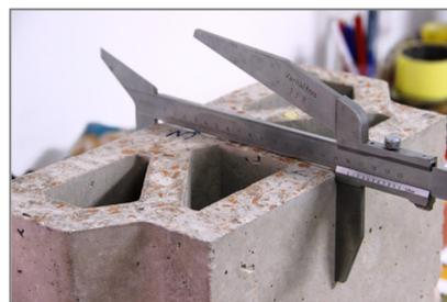
Slika 6. 5: Priprema uzoraka za ispitivanje
