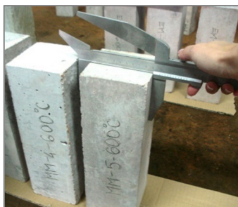
Slika 5. 14: Mjerenje dimenzija uzoraka
