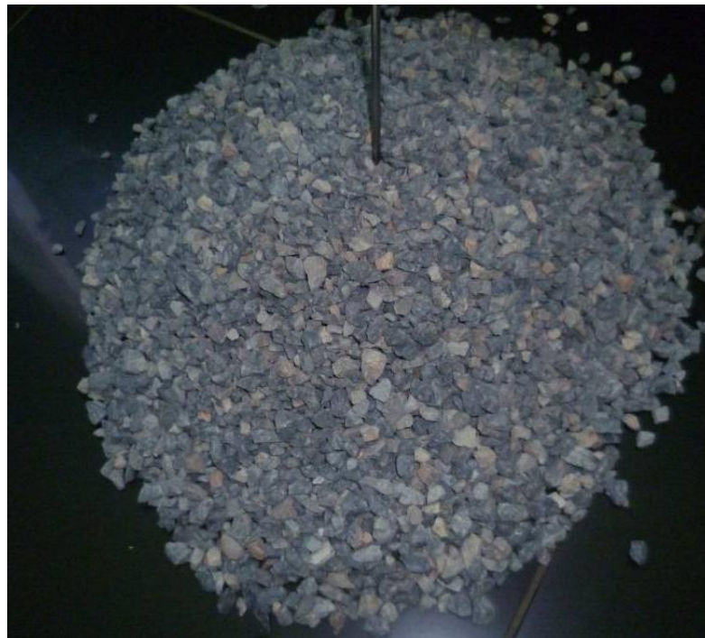
Slika 210. Ispitani uzorak kamene frakcije granulacije 4/8 mm
