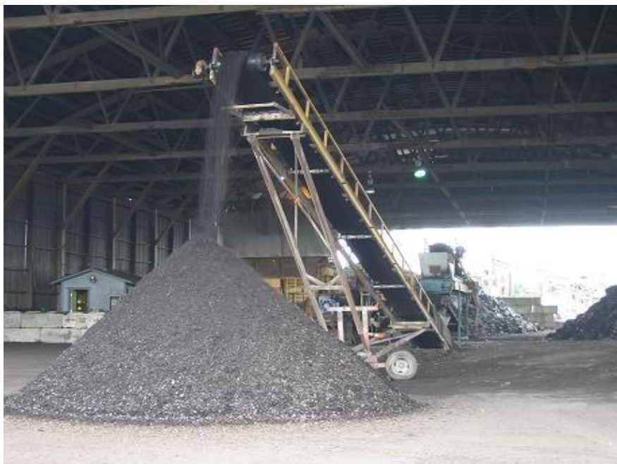
Slika 12. Natkrivena reciklirana asfaltna mješavina [100]
