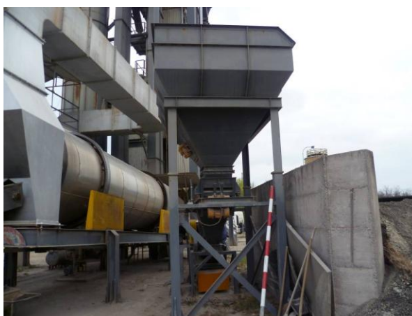
Slika 95. Rotacijski bubanj za sušenje i zagrijavanje (A.P. Orahovica – Gravia d.o.o.)
