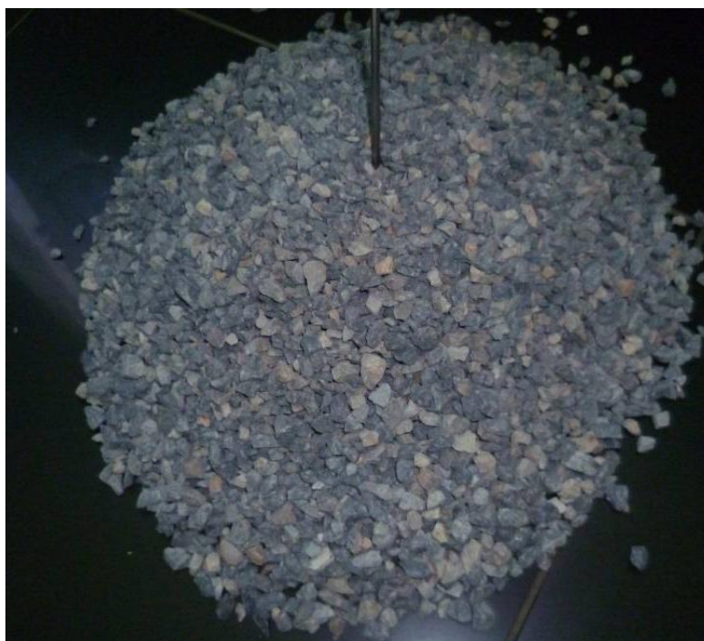
Slika 210. Ispitani uzorak kamene frakcije granulacije 4/8 mm
