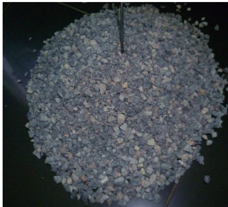
Slika 210. Ispitani uzorak kamene frakcije granulacije 4/8 mm
