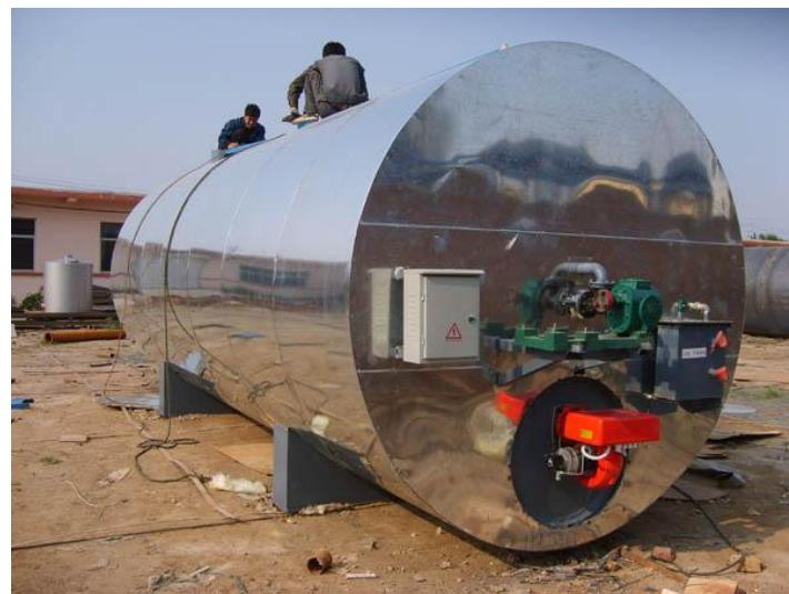
Slika 27. Spremnik za bitumen [129]
