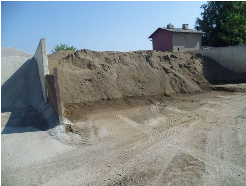
Slika 87. Deponija pijeska na betonskom postrojenju u Osijeku (Tehnika-Beton)
