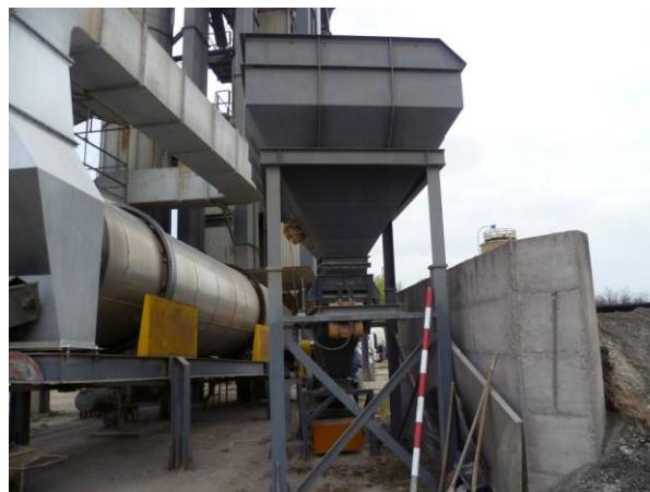
**Slika 95.** Rotacijski bubanj za sušenje i zagrijavanje (A.P. Orahovica – Gravia d.o.o.)
