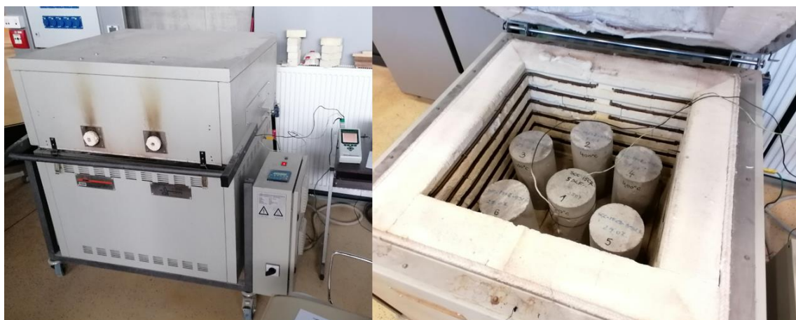
Slika 6.13 Električna peć korištena za ispitivanje otpornosti betonskih uzoraka valjaka na visoke temperature
