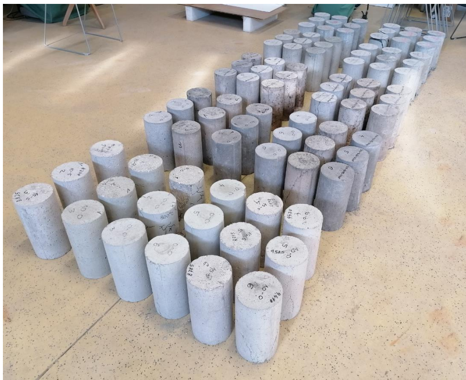
Slika 6.29 Promjena boje ispitanih betonskih uzoraka
