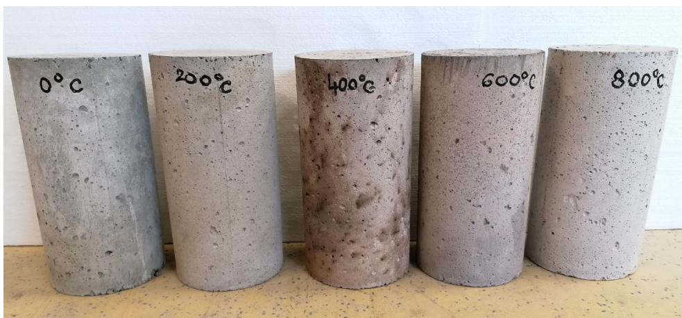
Slika 6.32 Promjena boje uzoraka betonske mješavine SCC-15CR-5SLF
