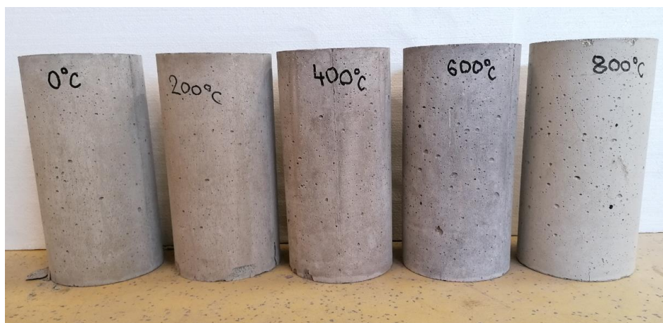
Slika 6.30 Promjena boje uzoraka referentne betonske mješavine SCC-0CR-0SLF
