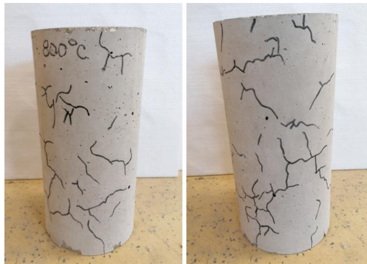
Slika 6.28 Pojava pukotina po cijeloj visini uzorka referentne betonske mješavine (800 °C)
