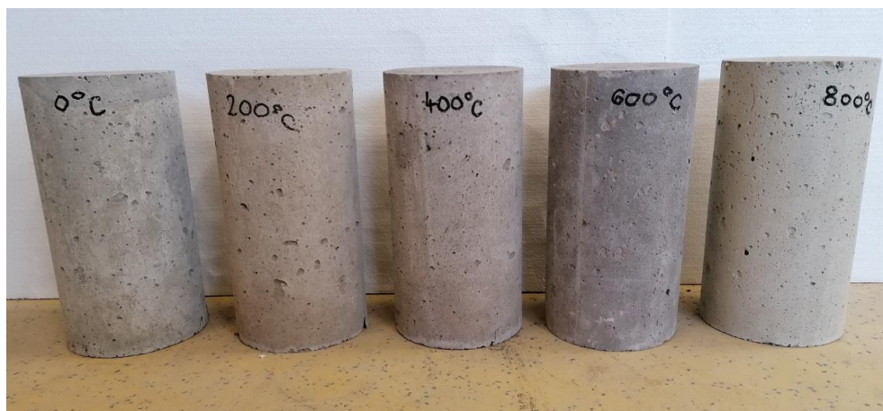
Slika 6.31 Promjena boje uzoraka betonske mješavine SCC-10CR-0SLF
