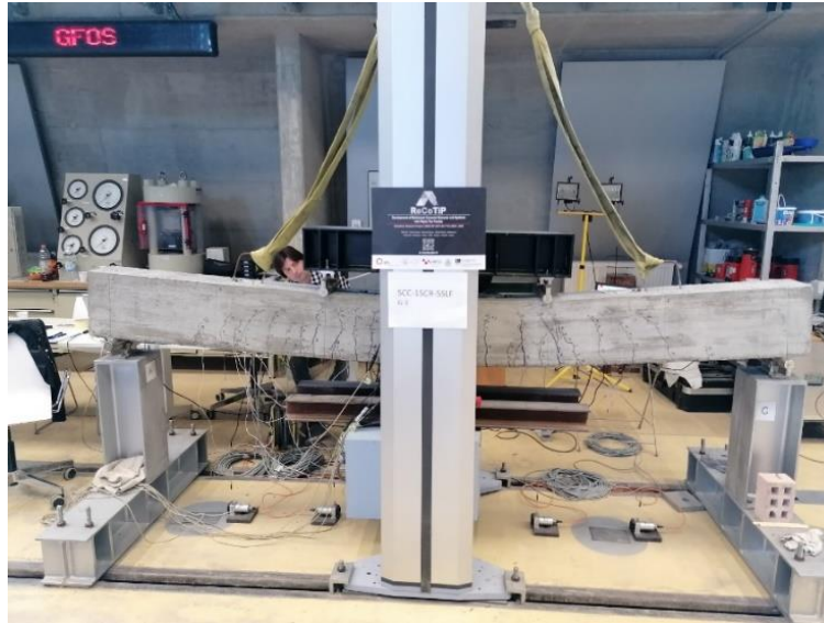
Slika 7.8 Laboratorijsko ispitivanje AB greda pomoću univerzalnog uređaja za vlačno-tlačno ispitivanje materijala i elemenata
