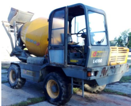
Slika 7.1 Samohodni utovarni mikser za pripremu betona CARMIX (zapremina 5 m 3 ) korišten prilikom izrade AB greda
