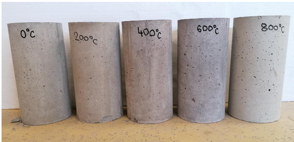
Slika 6.30 Promjena boje uzoraka referentne betonske mješavine SCC-0CR-0SLF
