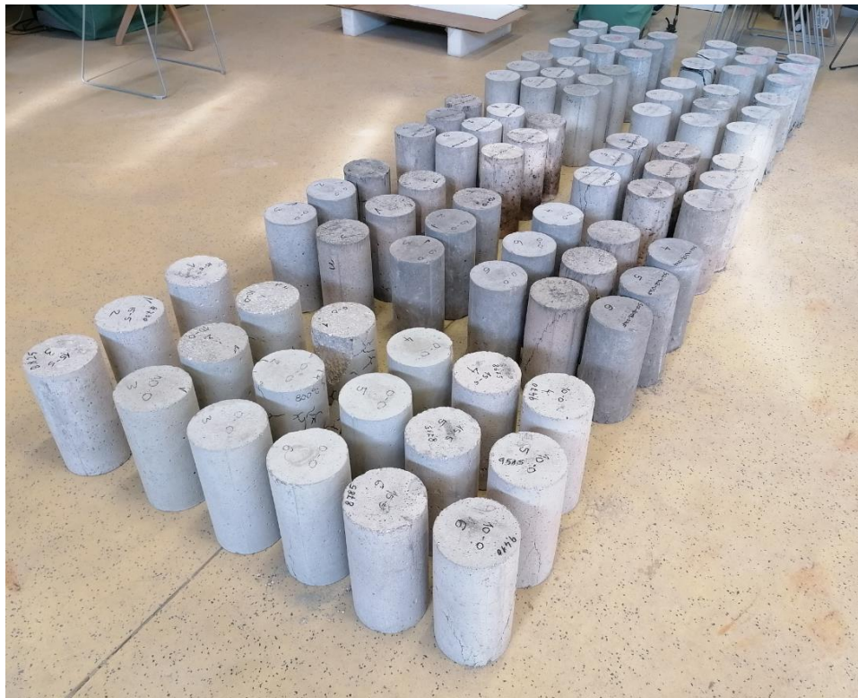
Slika 6.29 Promjena boje ispitanih betonskih uzoraka
