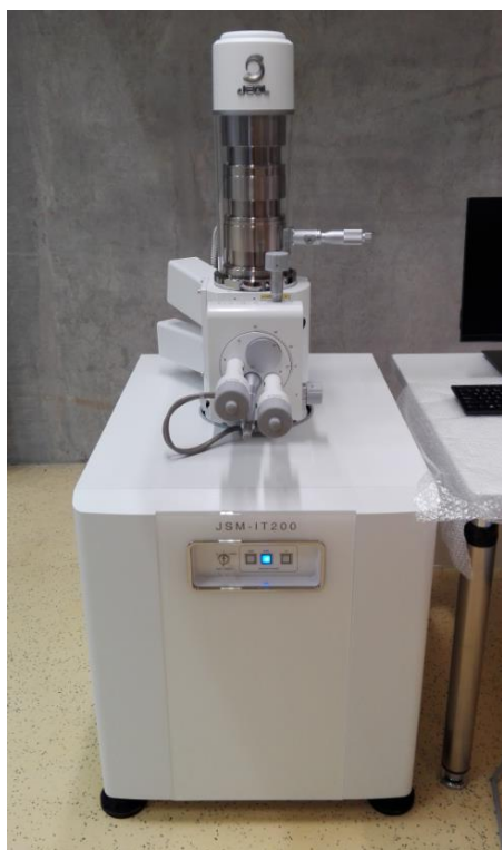
Slika 6.58 Pretražni elektronski mikroskop JEOL SEM JSM-IT200
