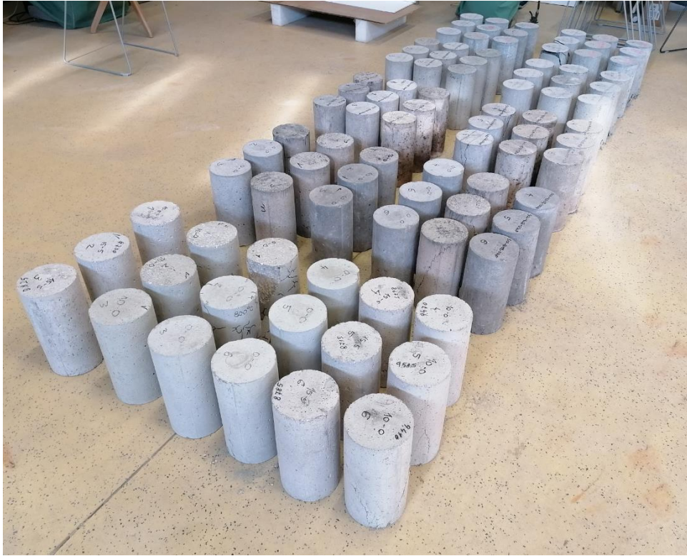
Slika 6.29 Promjena boje ispitanih betonskih uzoraka
