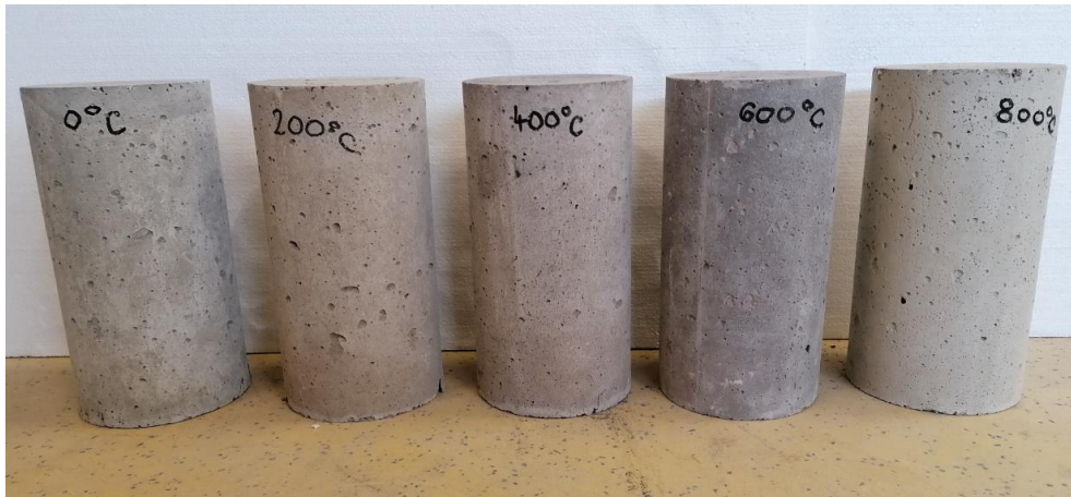
Slika 6.31 Promjena boje uzoraka betonske mješavine SCC-10CR-0SLF
