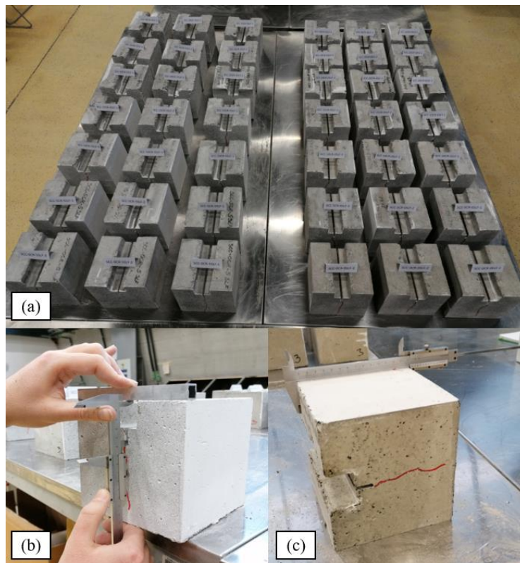
Slika 5.1 Geometrija uzorka: (a) uzorci kocki s usječenim prostorom za smještaj mehaničkih dijelova za prijenos sile i inicijalnim zarezom, (b) mjerenje duljine inicijalne pukotine (inicijalnog zareza) na dvije suprotne strane uzorka, (c) mjerenje visine uzorka na četiri ruba uzorka
