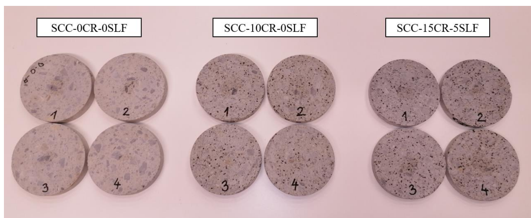
Slika 6.16 Betonski uzorci na kojima je ispitana toplinska vodljivost
