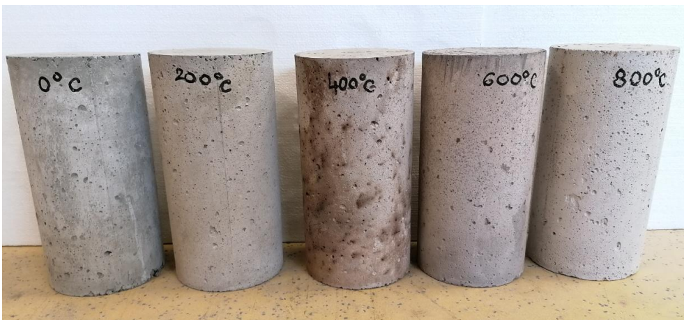
Slika 6.32 Promjena boje uzoraka betonske mješavine SCC-15CR-5SLF
