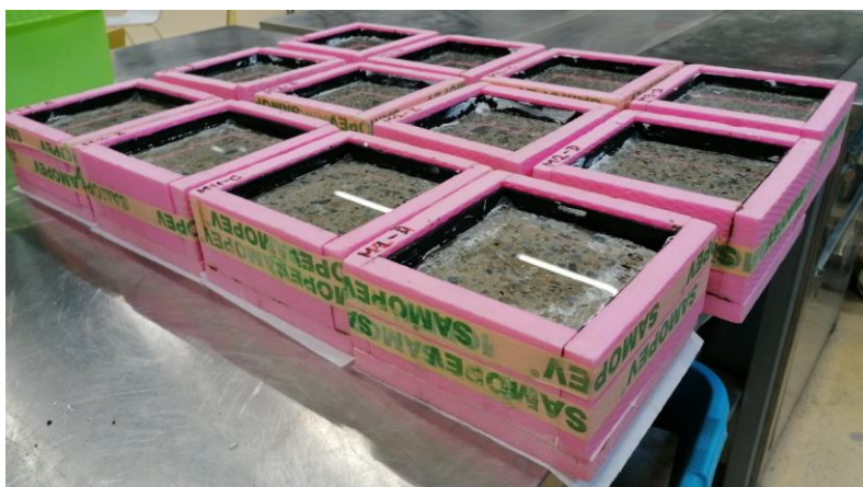
Slika 6.6 Betonski uzorci pripremljeni za ispitivanje otpornosti na cikluse smrzavanja i odmrzavanja
