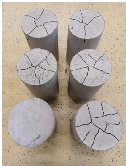
Slika 6.27 Pojava pukotina na dnu uzoraka referentne betonske mješavine (400 °C i 600 °C)
