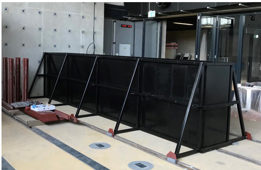
Slika 29. Spremnik za ugradnju modela tla.
