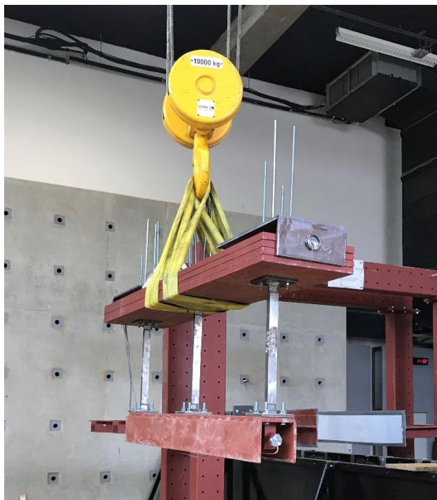
Slika 24. Pomicanje modela konstrukcije.
