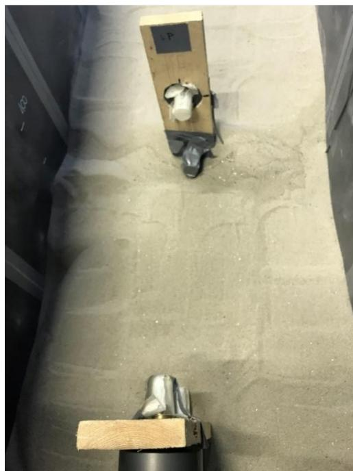
Slika 40. Benderovi elementi postavljeni u spremniku s pijeskom.
