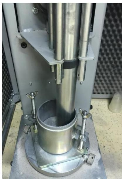
Slika 37. Ispitivanje Proctorovim postupkom.
