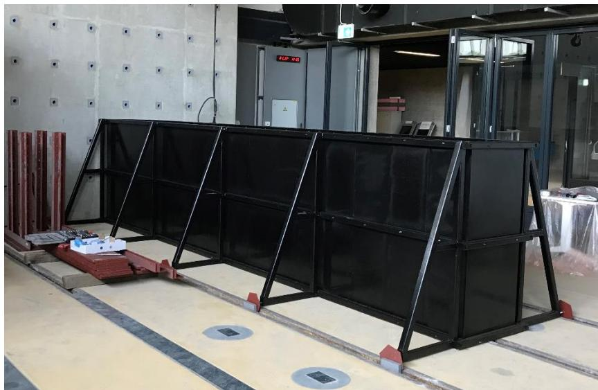
Slika 29. Spremnik za ugradnju modela tla.
