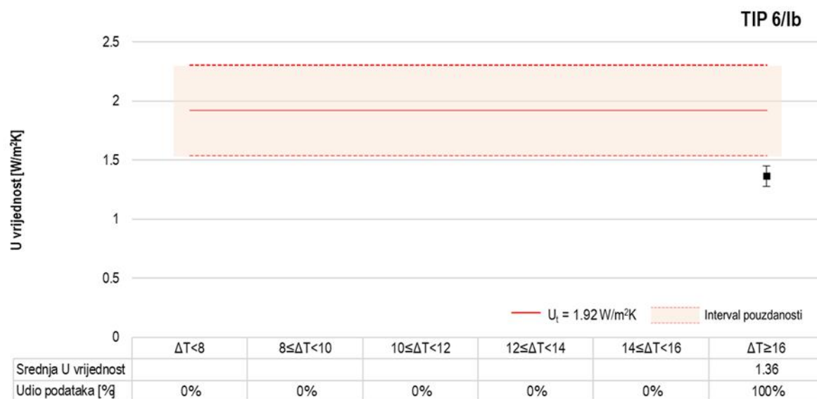
Slika 7.41 Srednje U vrijednosti u ovisnosti o temperaturnoj razlici, model TIP 6/lb
