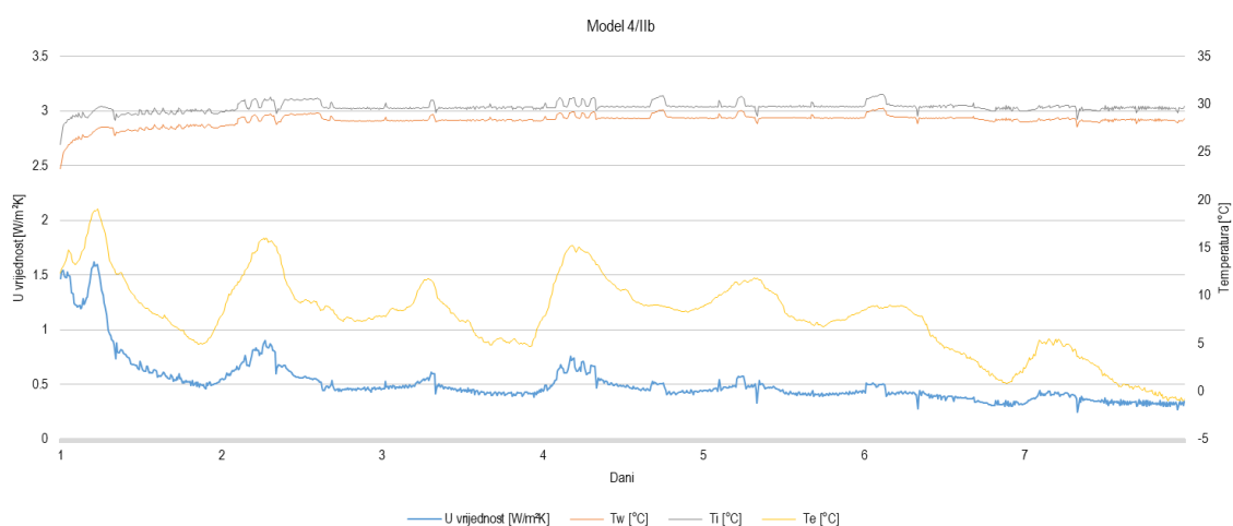
Slika 5.14 Prikaz U vrijednosti, unutarnje temperature zraka ( T_i ), vanjske temperature zraka ( T_e ) i temperature površine zida ( T_w ), model TIP 4/IIb
