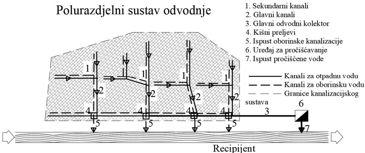
Slika 3.3. Polurazdjelni sustav odvodnje [151]
