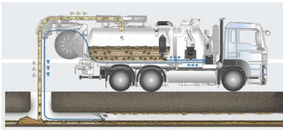
Slika 3.6. Kamion za čišćenje cijevi vodom pod pritiskom [203]
