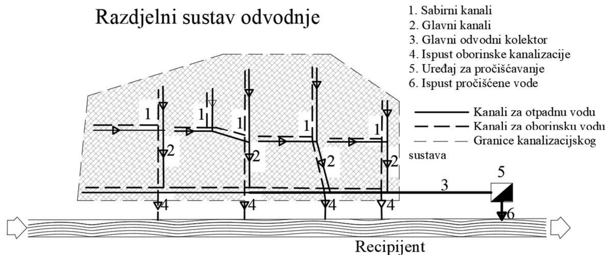
Slika 3.2. Razdjelni sustav odvodnje [151]
