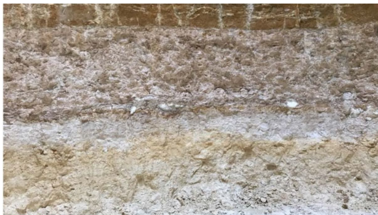
Slika 2.8. Od gore: Midra škriljavec sloj, Khor vapnenac sloj i Rus kalcificirani sloj, kao dio istraživanja u okviru doktorske disertacije koju je prvotno objavio Geotech Geol Eng (2021) izdavača Springer Nature u Vučemilović et al. 2021. [51]
