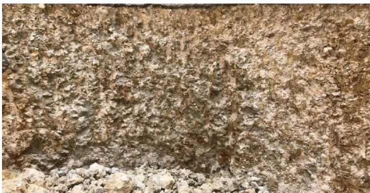
Slika 2.2. Trošni Simsima vapnenac sloj, kao dio istraživanja u okviru doktorske disertacije koju je prvotno objavio Geotech Geol Eng (2021) izdavača Springer Nature u Vučemilović et al. 2021. [51]
