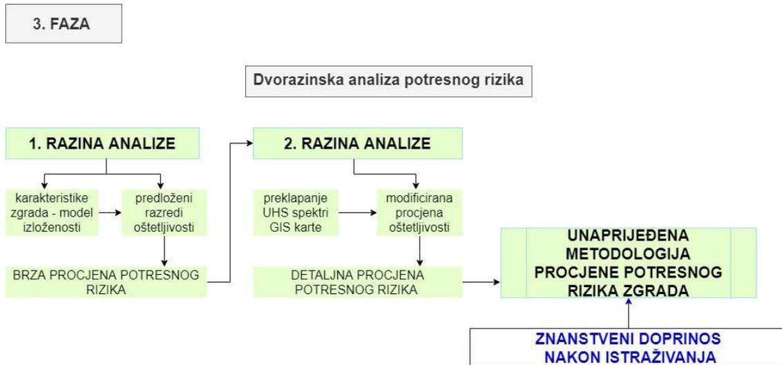
Slika 1.4 Shematski prikaz – unaprijeđena dvorazinska analiza potresnog rizika
