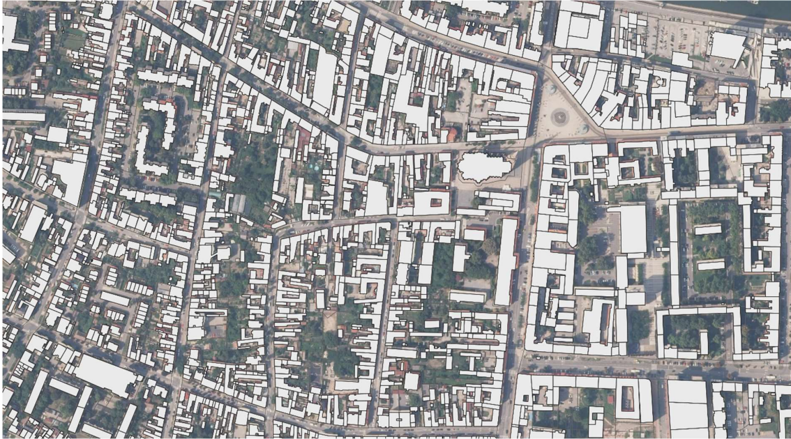
a) geometrijski definirane zgrade u QGIS-u
