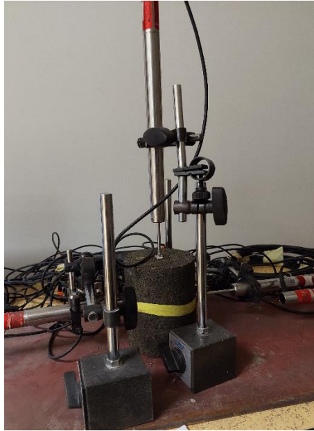
Slika 3.19. Mjerenje skupljanja uzorka
