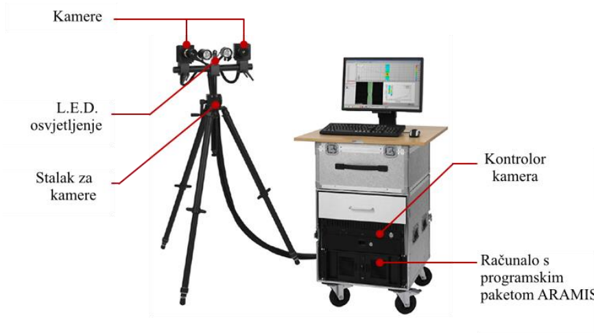
Slika 3.14. Sustav GOM ARAMIS za digitalnu stereo fotogrametriju
