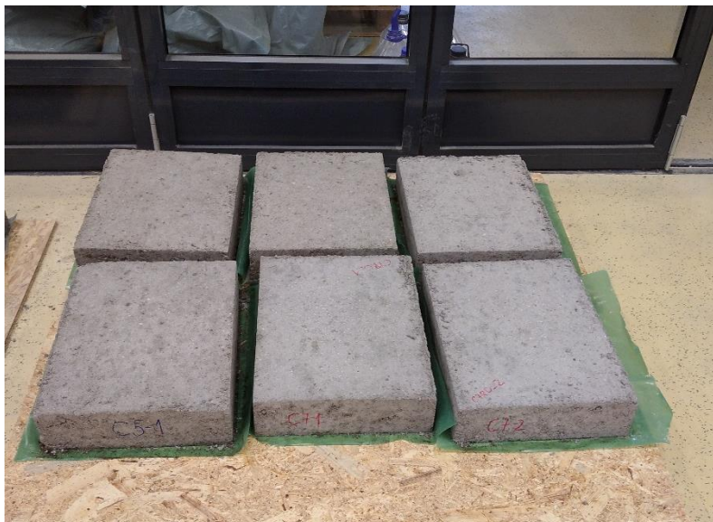
Slika 3.23. Ploče CNS-a nakon 28-dnevne njege
