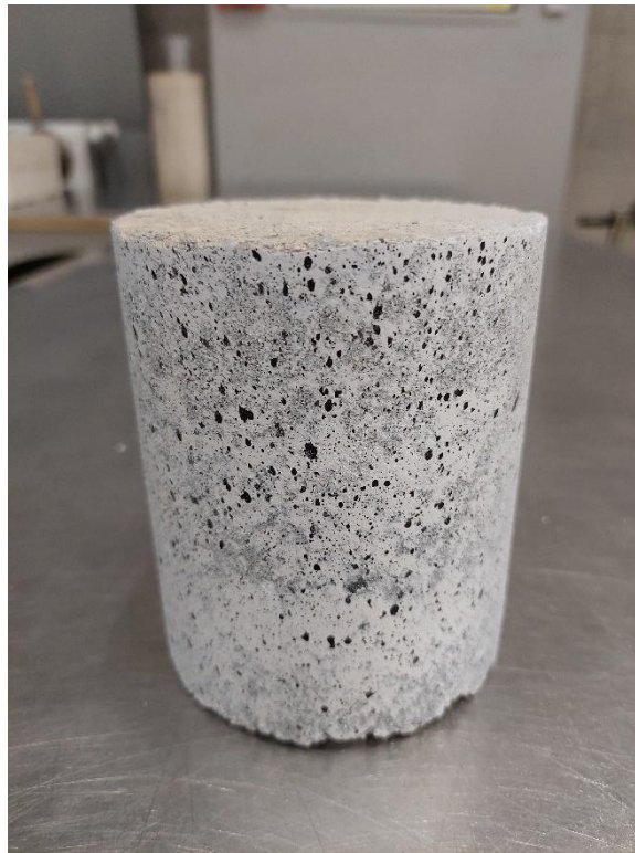
Slika 3.15. Uzorak pripremljen za ispitivanje statičkog modula elastičnosti
