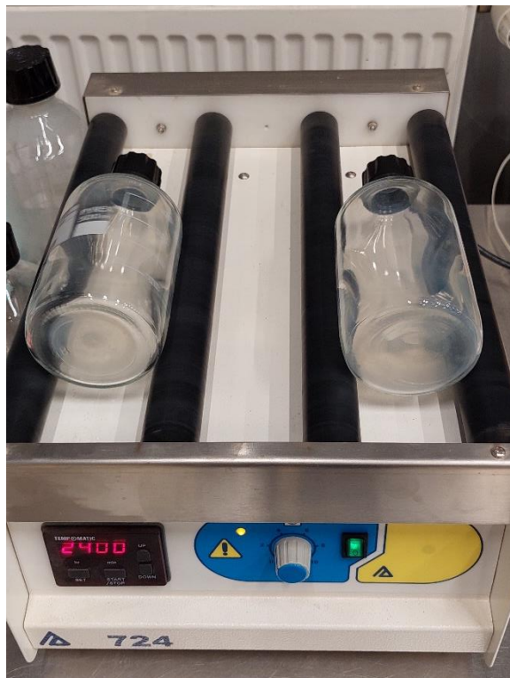
Slika 3.16. Postupak pripreme eluata
