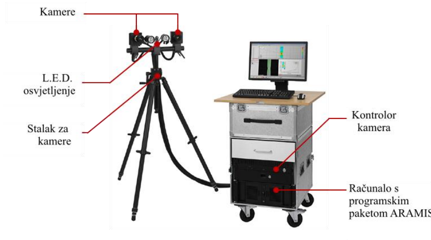
Slika 3.14. Sustav GOM ARAMIS za digitalnu stereo fotogrametriju
