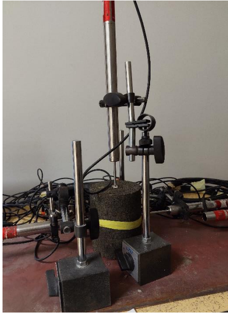
Slika 3.19. Mjerenje skupljanja uzorka
