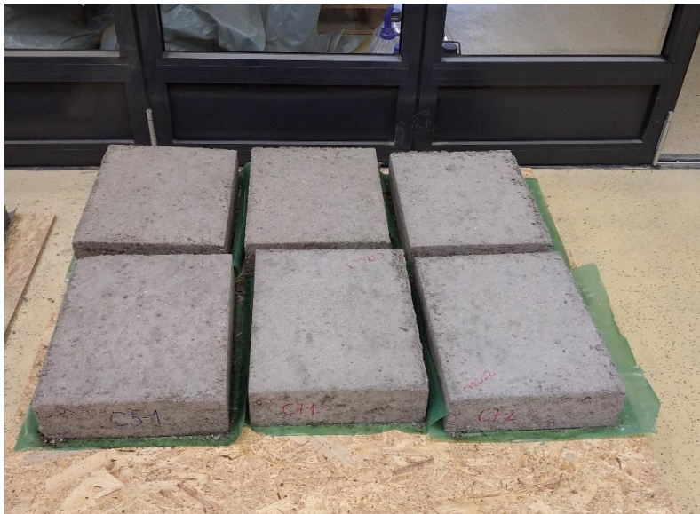
Slika 3.23. Ploče CNS-a nakon 28-dnevne njege
