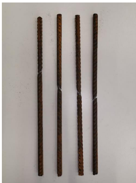
Slika 7.7. Ispitani uzorci uzdužne amature
