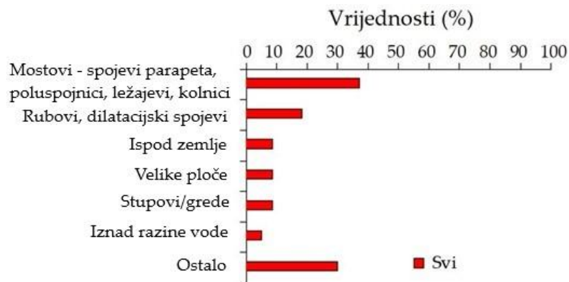
Slika 1.4. Betonski elementi skloni raspucavanju [1]
