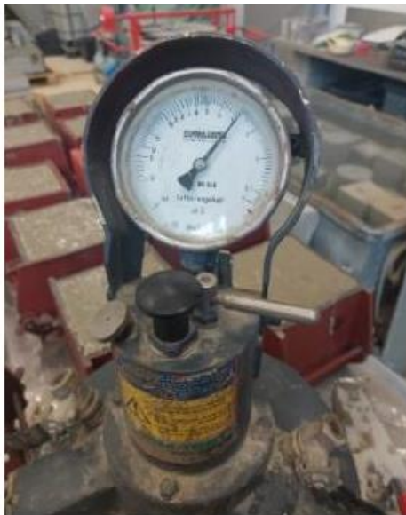
Slika 6.19. Određivanje udjela pora u betonu
