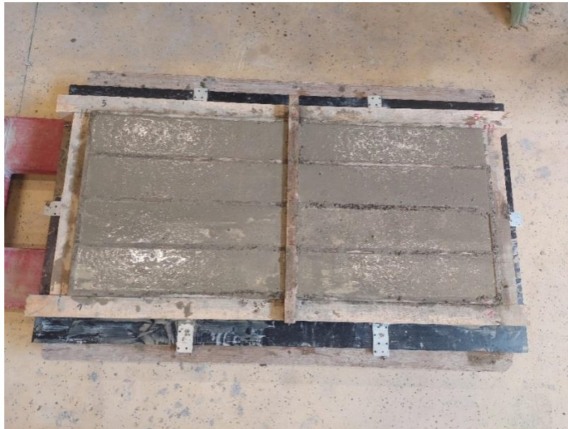
Slika 7.15. Svježi beton u oplati
