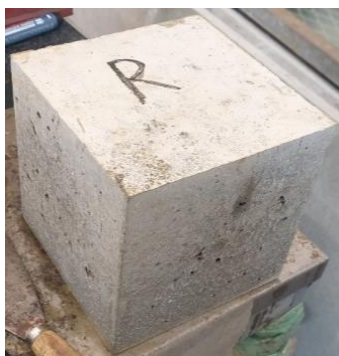
Slika 7.1. Betonske kocke izmjera 15 x 15 x 15 cm
