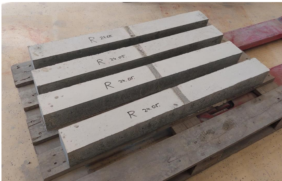
Slika 7.16. Raskalupljene grede referentne mješavine
