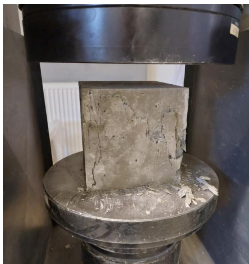
Slika 7.4. Ispitivanje tlačne čvrstoće betona
