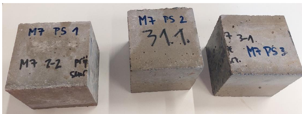
Slika 6.63. Betonske kocke mješavine M7 dimenzija 10 x 10 cm
