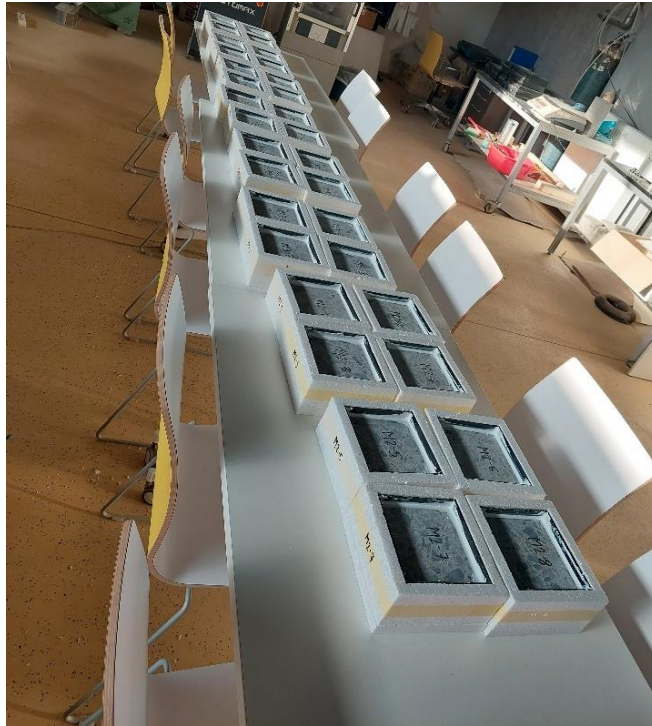
Slika 6.26. Plohe betona pripravljene za ispitivanje otpornosti na cikluse smrzavanja/odmrzavanja
