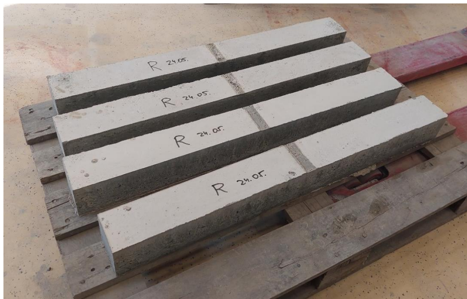
Slika 7.16. Raskalupljene grede referentne mješavine
