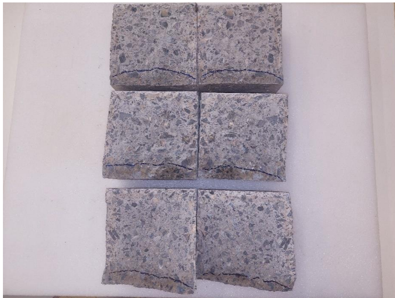
Slika 6.50. Uzorci nakon ispitivanja prodora vode pod tlakom
