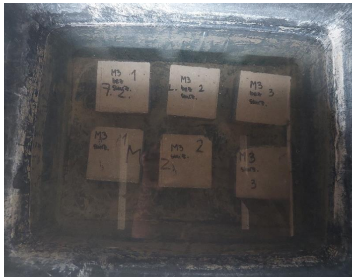
Slika 6.65. Samocijeljenje uzoraka mješavine M3 u vodi
