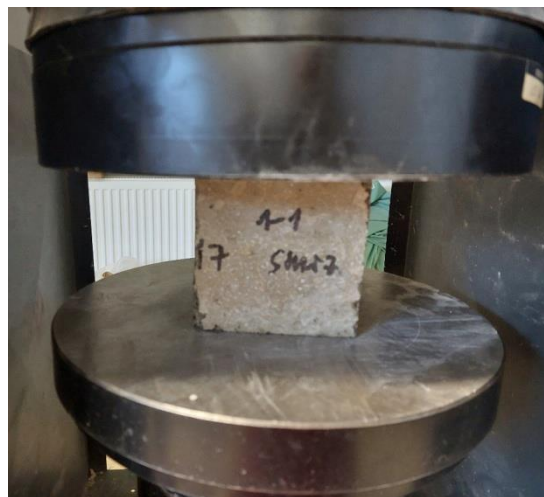
Slika 6.64. Iniciranje pukotina ispitivanjem tlačne čvrstoće kocke mješavine M7 dimenzija 10 x 10 cm, nakon 56 ciklusa smrzavanja
