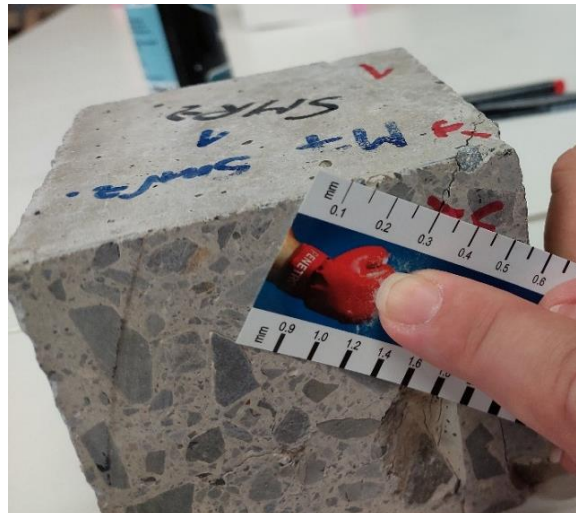
Slika 6.66. Označavanje i mjerenje širine pukotina na kockama dimenzija 10 x 10 x 10 cm – M7, nakon 56 ciklusa smrzavanja i odmrzavanja prije samocijeljenja
