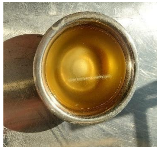
Slika 6.5. Superplastifikator Visco Crete 5380 I
