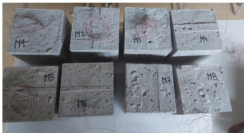
Slika 6.22. Kocke betona s ugrađenim termoparovima
