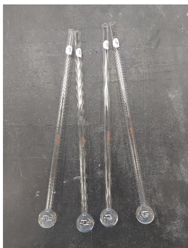
Slika 6.3. Priprema uzoraka za ispitivanje specifične površine
