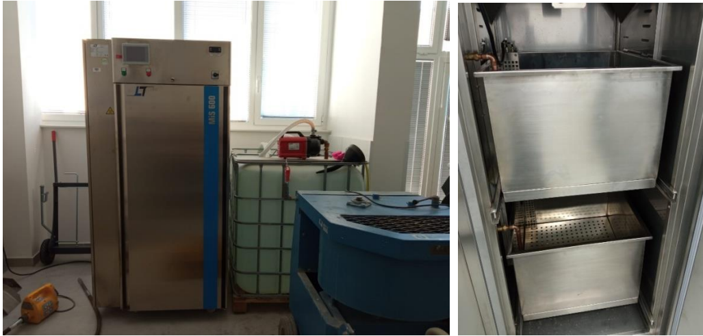
Slika 6.38. Komora za ispitivanje kocaka i prizmi betona na cikluse smrzavanja i odmrzavanja
