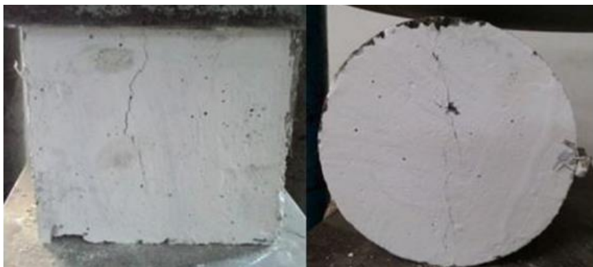
Slika 3.18. Proces prije pucanja betonskog uzorka [53]
