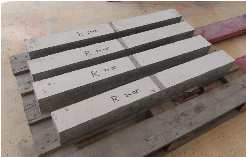
Slika 7.16. Raskalupljene grede referentne mješavine
