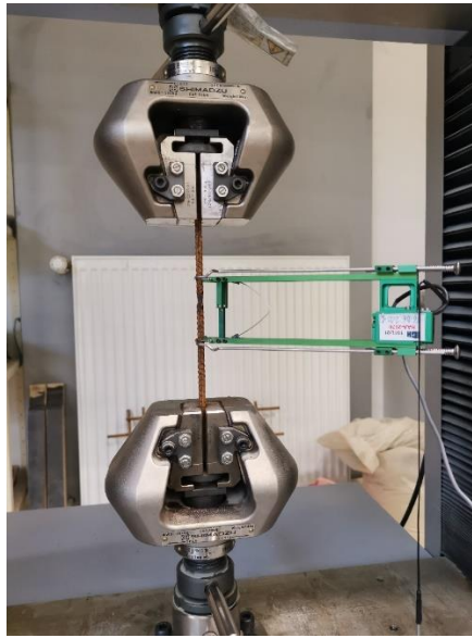
Slika 7.5. Ispitivanje poprečne armature na kidalici Shimadzu
