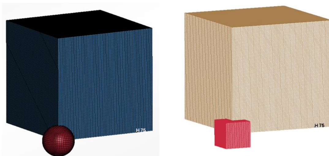
Slika 6.25 Numerički modeli podvodne eksplozije s različitim oblikom eksplozivnog naboja, kugla (lijevo) i kocka (desno)
