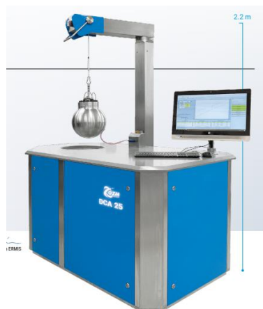
Slika 3.38 Detonacijski kalorimetar (CCA 25) [58]
