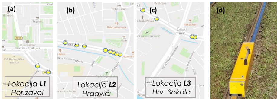
Slika 1. Lokacije mjerenja ravnosti vozne površine tračnica (a,b,c) i prikaz rada uređaja za mjerenje ravnosti tračnica (d)
