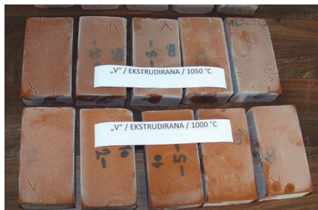
Slika 10. Izgled strojno izrađene opeke "V" nakon izlaganja ciklusima smrzavanja/odmrzavanja
