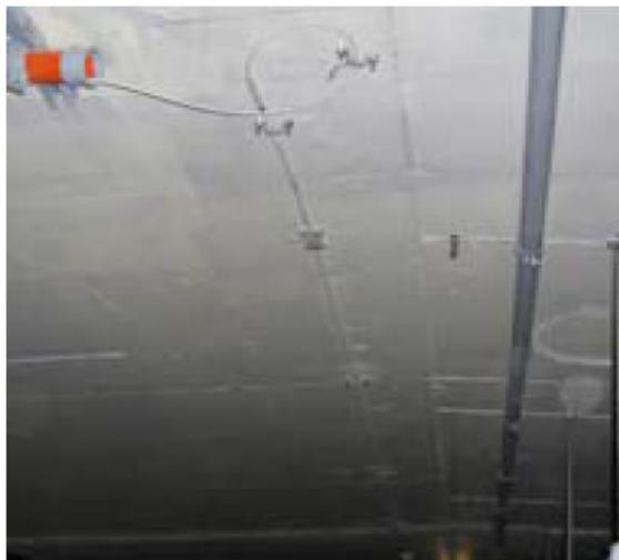
Slika 17 – Optički senzorni kabeli
