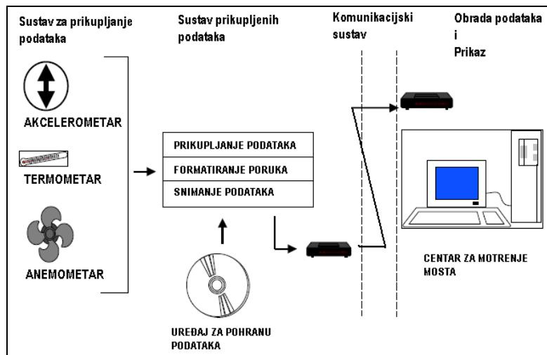
**Slika 4 – Kontinuirano motrenje, prikupljanje i obrada podataka**
