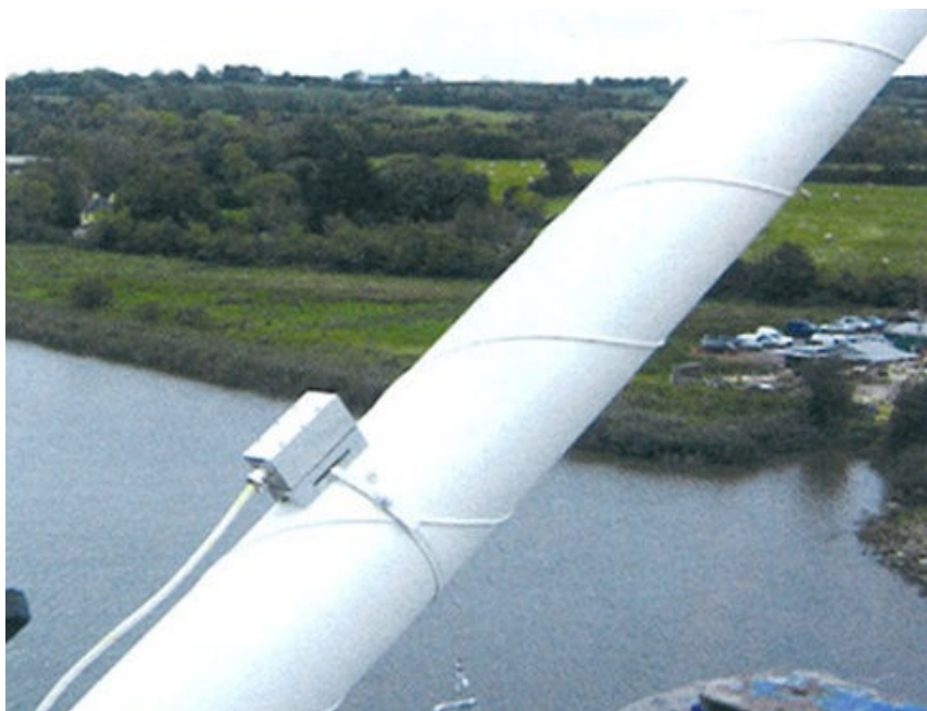
Slika 15 – Akcelerometar pričvršćen za jednu vješaljku
