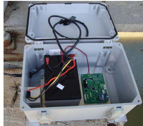
Slika 13 – Akcelerometar u zaštitnoj kutiji, prijenos podataka bežičan
