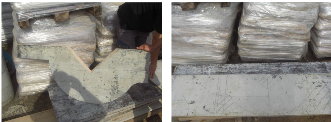
Slika 6 - Izrada trokutnog Thomsonovog preljeva
