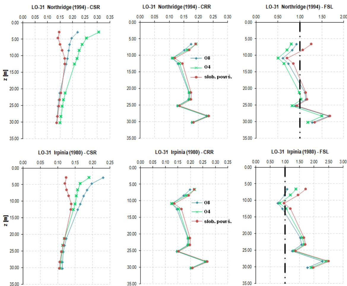
**Slika 13 - Raspodjela omjera cikličkih naprezanja CSR, omjera cikličke otpornosti CRR i faktora sigurnosti od likvefakcije po dubini profila LO-31 za potres: Northridge 1994 (gore) i Irpinia 1980 (dolje)**
