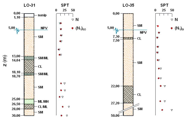
**Slika 7 - Raspodjela karakterističnih slojeva i rezultata mjerena standardnim penetracijskim pokusom (SPT) po dubini profila tla razmatranih u radu [14]**
