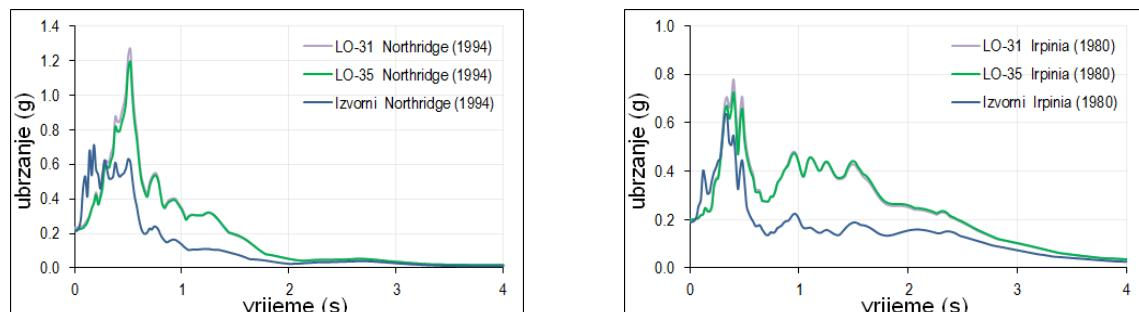
**Slika 10 - Spektri odziva izvornih i modificiranih potresa: Northridge 1994 (lijevo) i Irpinia 1980 (desno)**
