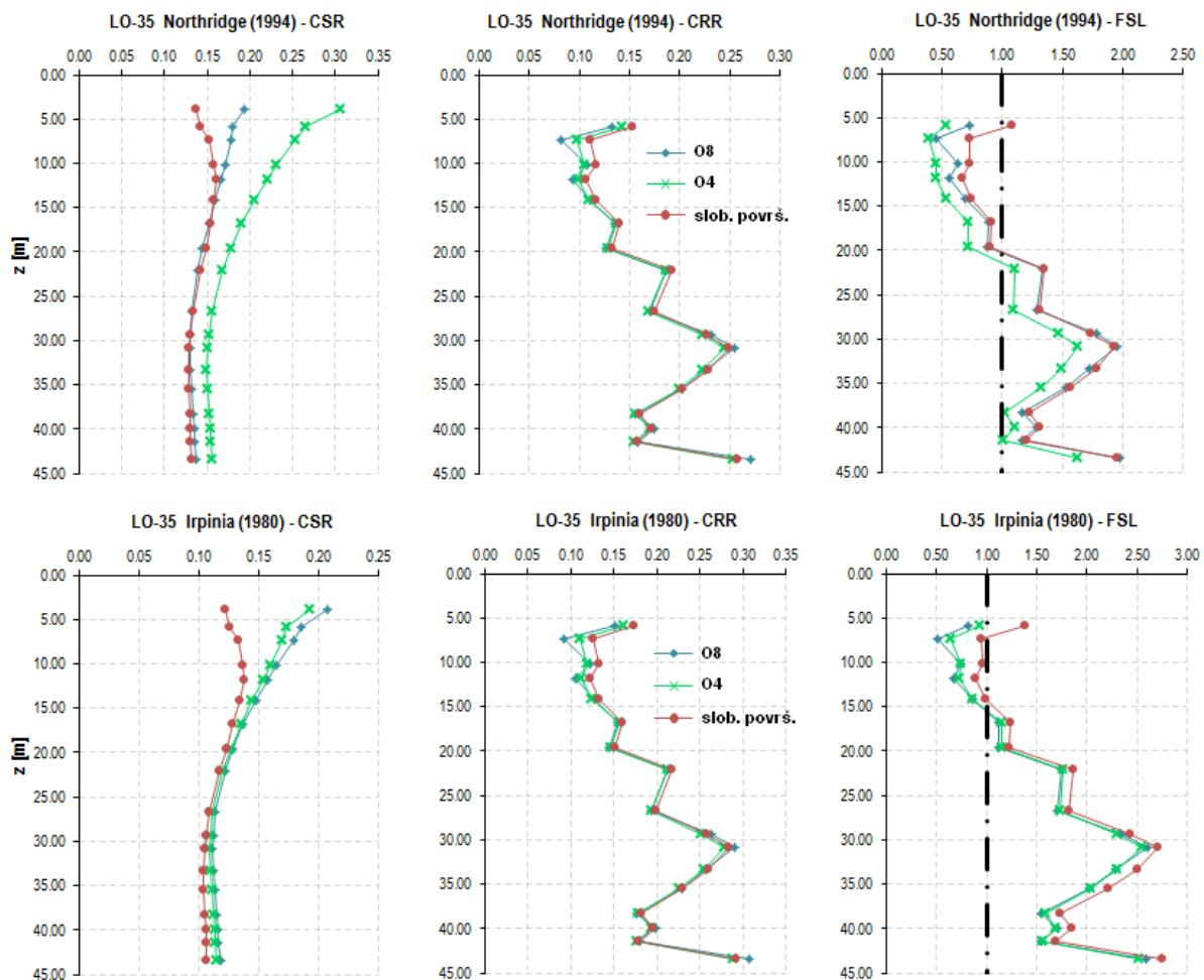
**Slika 12 - Raspodjela omjera cikličkih naprezanja CSR, omjera cikličke otpornosti CRR i faktora sigurnosti od likvefakcije po dubini profila LO-35 za potres: Northridge 1994. (gore) i Irpinia 1980. (dolje)**
