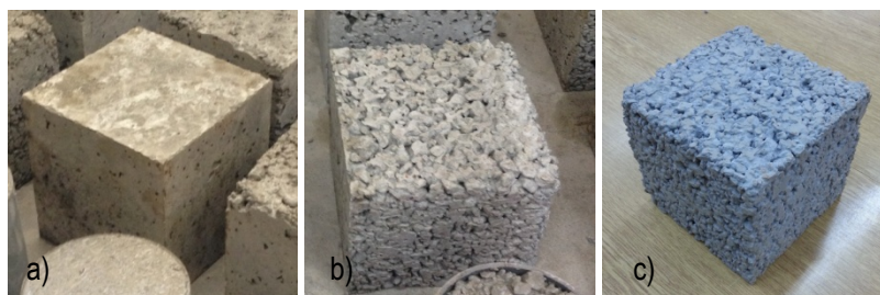
Slika 1 - Uzorci (kocke) očvrstloga poroznog betona: a) M1; b) M2; c) M3
