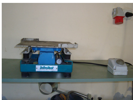
Slika 4 – Vibrostol za zbijanje svježeg morta
