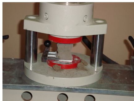
Slika 8 - Ispitivanje tlačne čvrstoće morta
