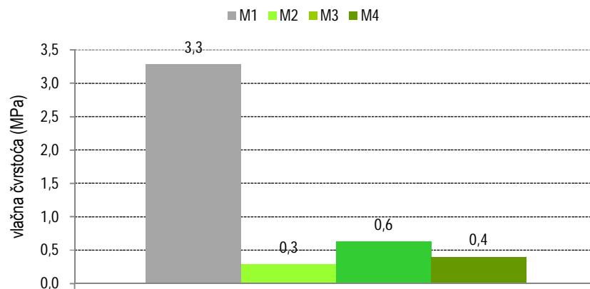
Slika 9 - Vlačne čvrstoće morta savijanjem nakon 2 dana starosti uzoraka
