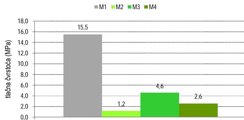
**Slika 11 - Tlačne čvrstoće morta nakon 2 dana starosti uzorka**
