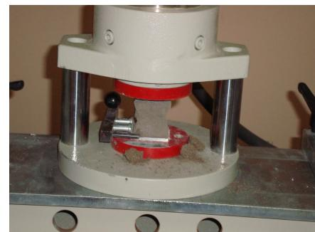
Slika 8 - Ispitivanje tlačne čvrstoće morta
