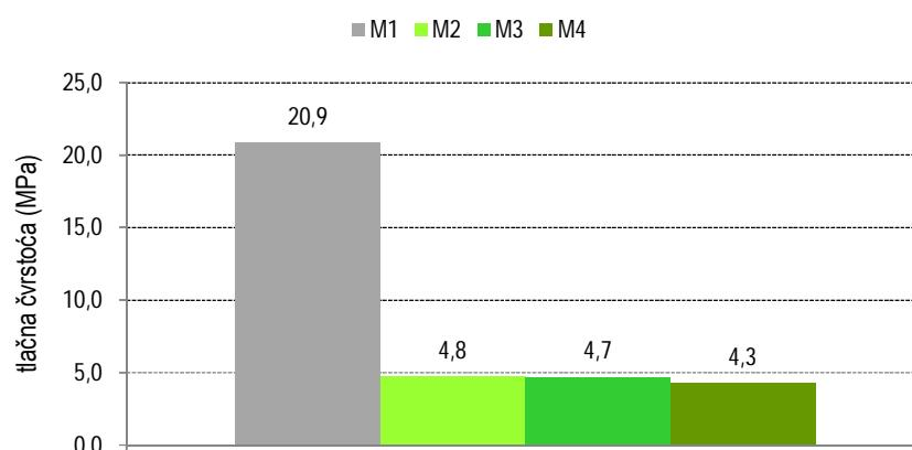
**Slika 12 - Tlačne čvrstoće morta nakon 28 dana starosti uzorka**
