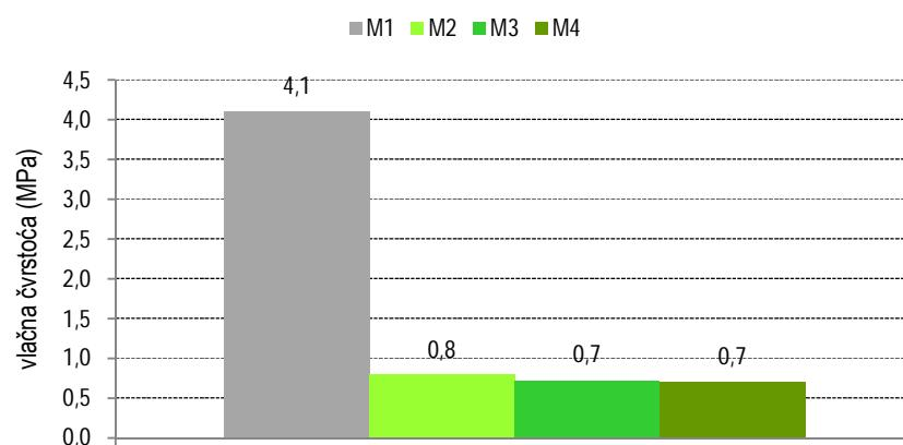
**Slika 10 - Vlačne čvrstoće morta savijanjem nakon 28 dana starosti uzorka**
