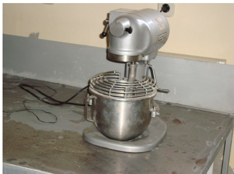
Slika 2 - Miješalica za spravljanje mješavina morta
