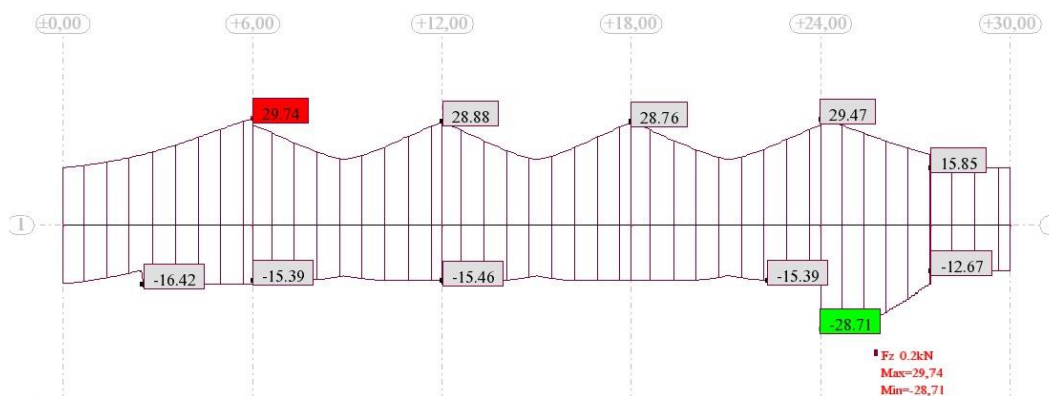
Slika 6 - Anvelopa poprečnih sila V_{y,Ed} (skupina opterećenja 1, najveća poprečna sila V_{y,Ed} )
