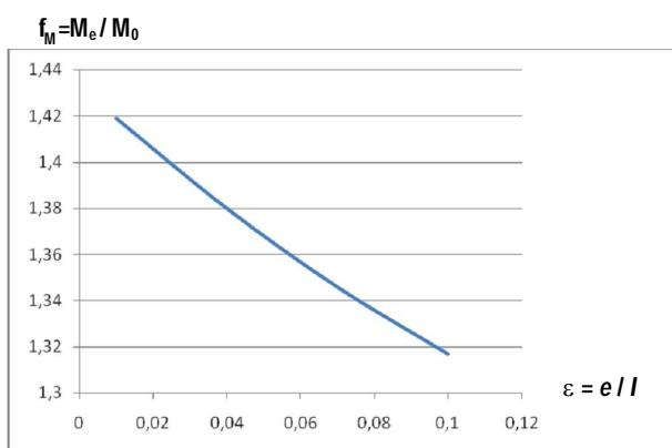
**Slika 11 – Promjenjivost momenta u tlačnom pojusu – ekscentricitet u oba pojasa**
