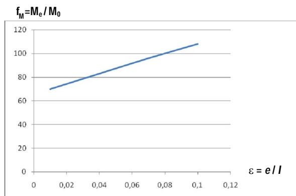
**Slika 9 – Promjenjivost momenta u tlačnoj ispunji – ekscentricitet u gornjem pojasu**
