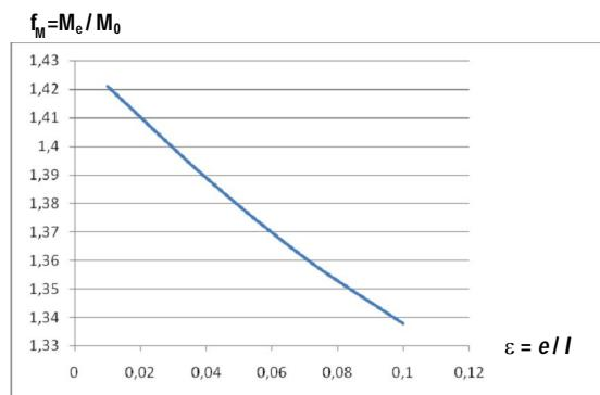
**Slika 7 – Promjenjivost momenta u tlačnom pojusu – ekscentricitet u gornjem pojusu**
