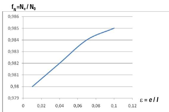
**Slika 8 – Promjenjivost uzdužne sile u tlačnom pojusu – ekscentricitet u gornjem pojusu**
