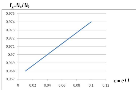
Slika 4 – Promjenjivost uzdužne sile u tlačnom pojusu – ekscentricitet u donjem pojusu
