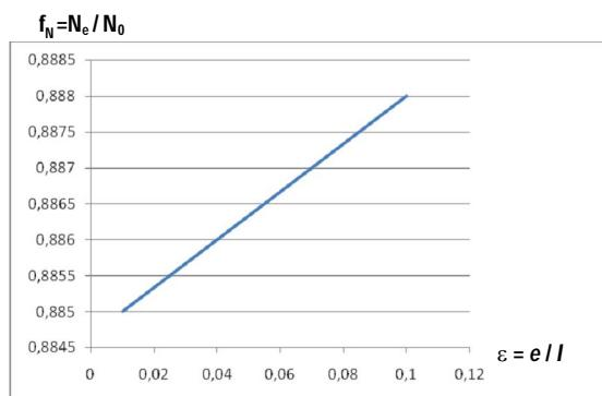
**Slika 6 – Promjenjivost uzdužne sile u tlačnoj ispunji – ekscentricitet u donjem pojasu**
