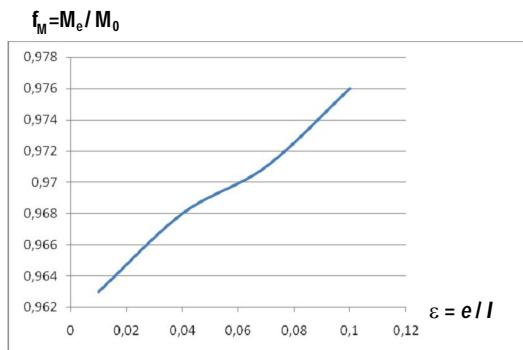
Slika 3 – Promjenjivost momenta u tlačnom pojusu – ekscentricitet u donjem pojusu
