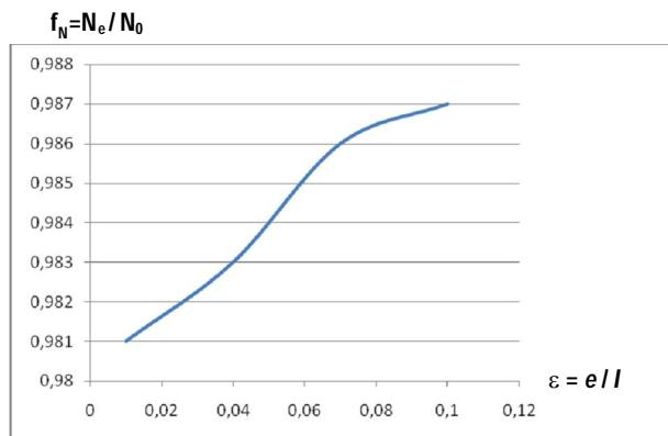
Slika 12 – Promjenjivost uzdužne sile u tlačnom pojusu – ekscentricitet u oba pojasa
