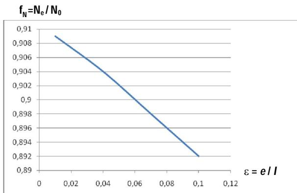
**Slika 10 – Promjenjivost uzdužne sile u tlačnoj ispunji – ekscentricitet u gornjem pojasu**
