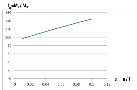
Slika 5 – Promjenjivost momenta u tlačnoj ispuni – ekscentricitet u donjem pojusu
