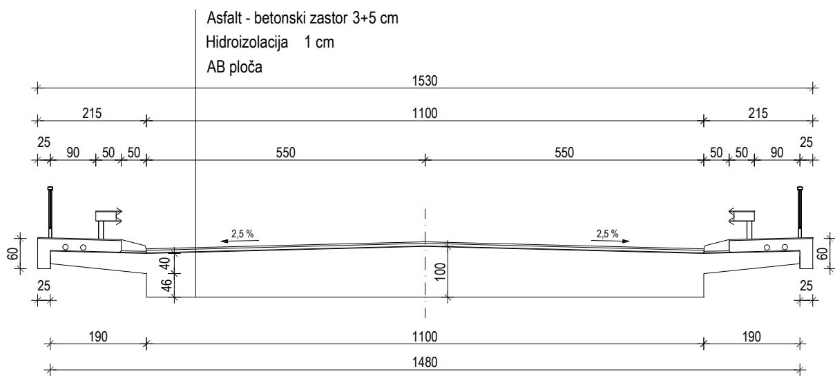
**Slika 8a – Poprečni presjek pločastog mosta u polju**
