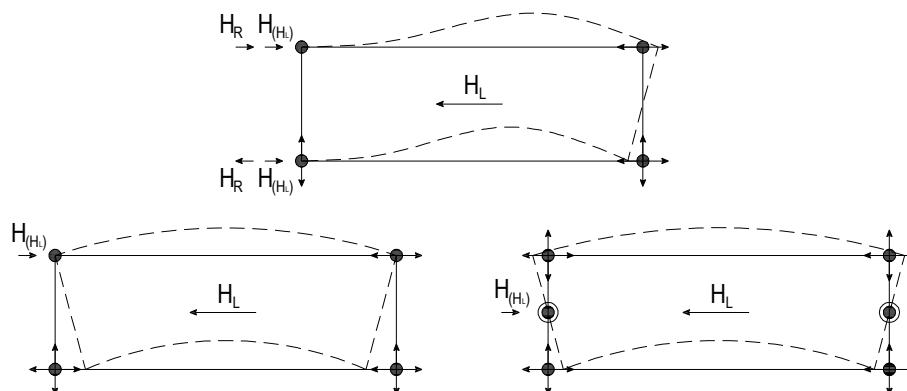
Slika 2 – Varijante tlocrtnog rasporeda ležajeva jednorasporskog mosta s dvama glavnim nosačima
