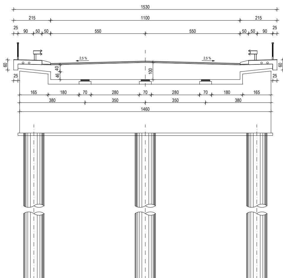
**Slika 8b – Poprečni presjek pločastog mosta pri upornjaku**
