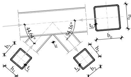
Priklučak u rešetkastom nosaču, označen s 2 (pogledati poglavlje 3.1, slika 3), detaljno je prikazan u tablici s proračunom. Proračun tog priključka je isti i u slučaju druga dva pretpostavljeni modela, pa nadalje neće biti prikazani. Kod ovakvog pretpostavljenog modela (model s centričnim sustavom u kojem podrazumijevamo zglobne veze) je zaključeno da je priključak 3 (slika 3) kritičan priključak u kojem je uočeno otkazivanje preko otkazivanja vlačne ispune zbog smanjenja efektivne širine.
