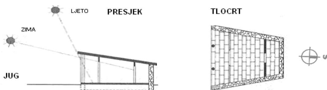
Slika 3 - Sokratova kuća trapeznog oblika s tlocrtom orijentiranom prema jugu
