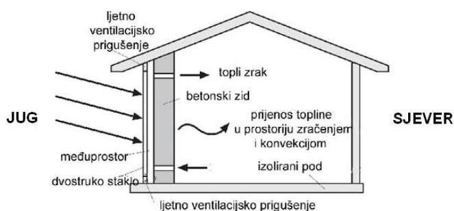
Slika 9 - Trombov zid
