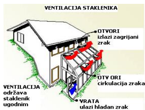
Slika 14 - Prikaz funkcioniranja ventilacije staklenika
