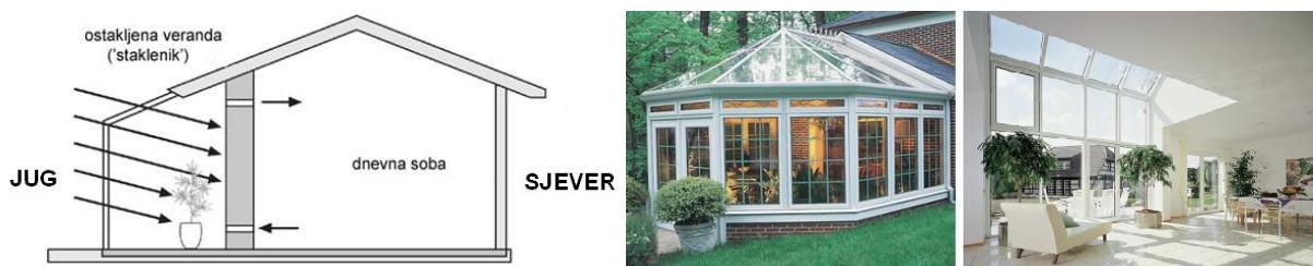
**Slika 13 – Staklenik - shematski presjek i dva primjera izvedbe**
