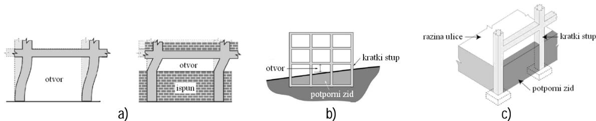
**Slika 2 – Primjeri mesta u zgradama gdje se može pronaći kratki stup, [3]: a) zgrada s okvirima s visokim parapetom; b) zgrada na kosom terenu; c) zgrada s djelomično ukopanim podrumom**
