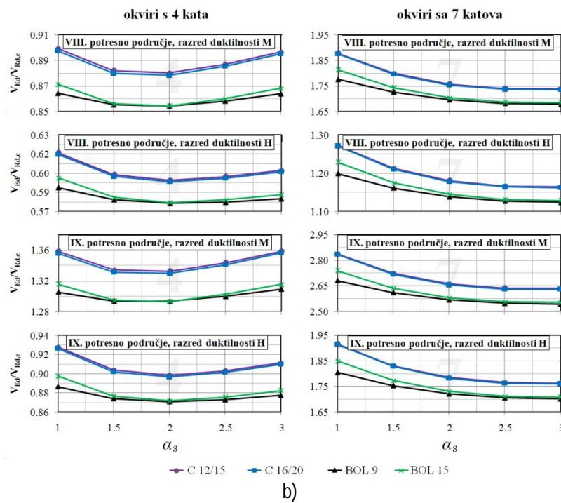
Slika 6 – Omjer proračunske poprečne sile  $V_{Ed}$  i proračunske nosivosti na poprečnu silu presjeka elementa bez poprečne armature  $V_{Rd,c}$ , ovisno o posmčnoj vitkosti kratkog stupa  $\alpha_s$  za: a) vanjski stup; b) unutarnji stup
