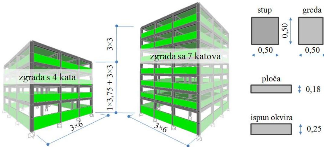
Slika 4 – Geometrija sastavnih elemenata konstrukcije (m)
