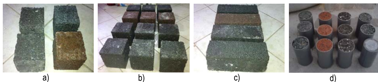
Slika 8 – Očvrsnuli uzorci propusnog betona: a) kocke stranice 10 cm; b) kocke stranice 15 cm; c) prizme izmjera 10/10/40 cm; d) valjci promjera 7,5 cm i visine 15 cm
