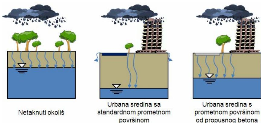
**Slika 1 - Utjecaj propusnog betona na razinu podzemnih voda u urbanim sredinama [5]**
