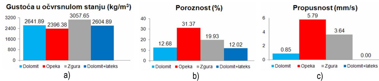
**Slika 10 - Fizikalna svojstva propusnog betona: a) gustoća u očvrsnulom stanju; b) poroznost; c) propusnost**
