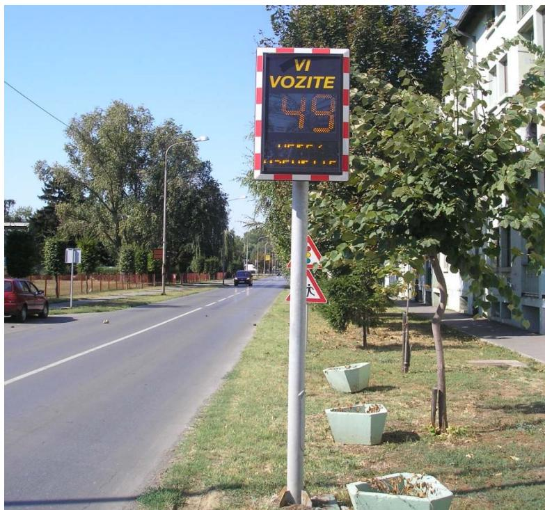
**Slika 6 - Smirivanje prometa uređajem za određivanje brzine vožnje**
