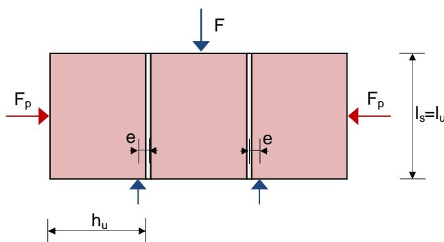
**Slika 4 – Opterećenje uzorka pri ispitivanju na posmik**
