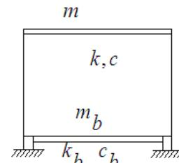
Slika 6b - Izolirana konstrukcija
