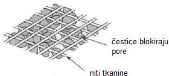
Slika 8 - Blokiranje pora geotekstila [9]
