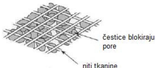
Slika 8 - Blokiranje pore geotekstila [9]
