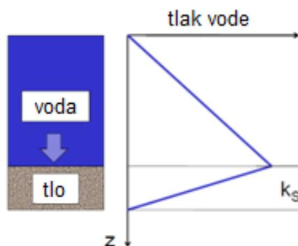
Slika 10 - Krivulja pornog tlaka u slučaju kada u tlu nema filtra;  $k_s$  = propusnot tla [6]
