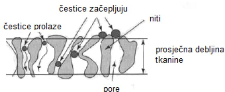
Slika 9 - Začepljenje pore geotekstila [9]
