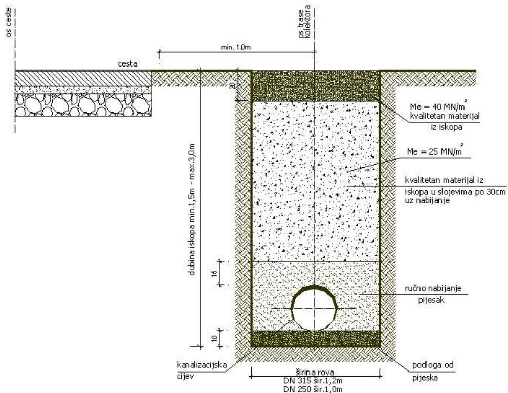
Slika 9 - Normalni poprečni profil rova kanalizacije [3]
