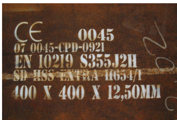
Slika 2 – Oznaka kvalitete čelika za proizvodnju nosača
