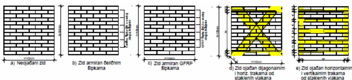
Slika 2 – Vrste ispitivanih zidnih uzoraka [10]
