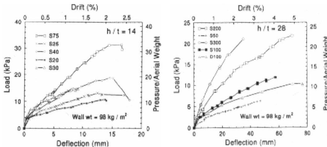
**Slika 1 - Ovojnica opterećenje-progib za kratke i za vitke zidove [9]**
